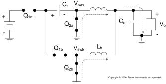
图 46. Phase A/B Low Side MOSFET On
