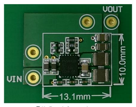
图 63. Example Converter Layout
