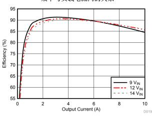
1.8 V<sub>OUT</sub>,2MHz(每相位),外部 VG+,3.2mm x 2.5mm x 1.2mm 电感
