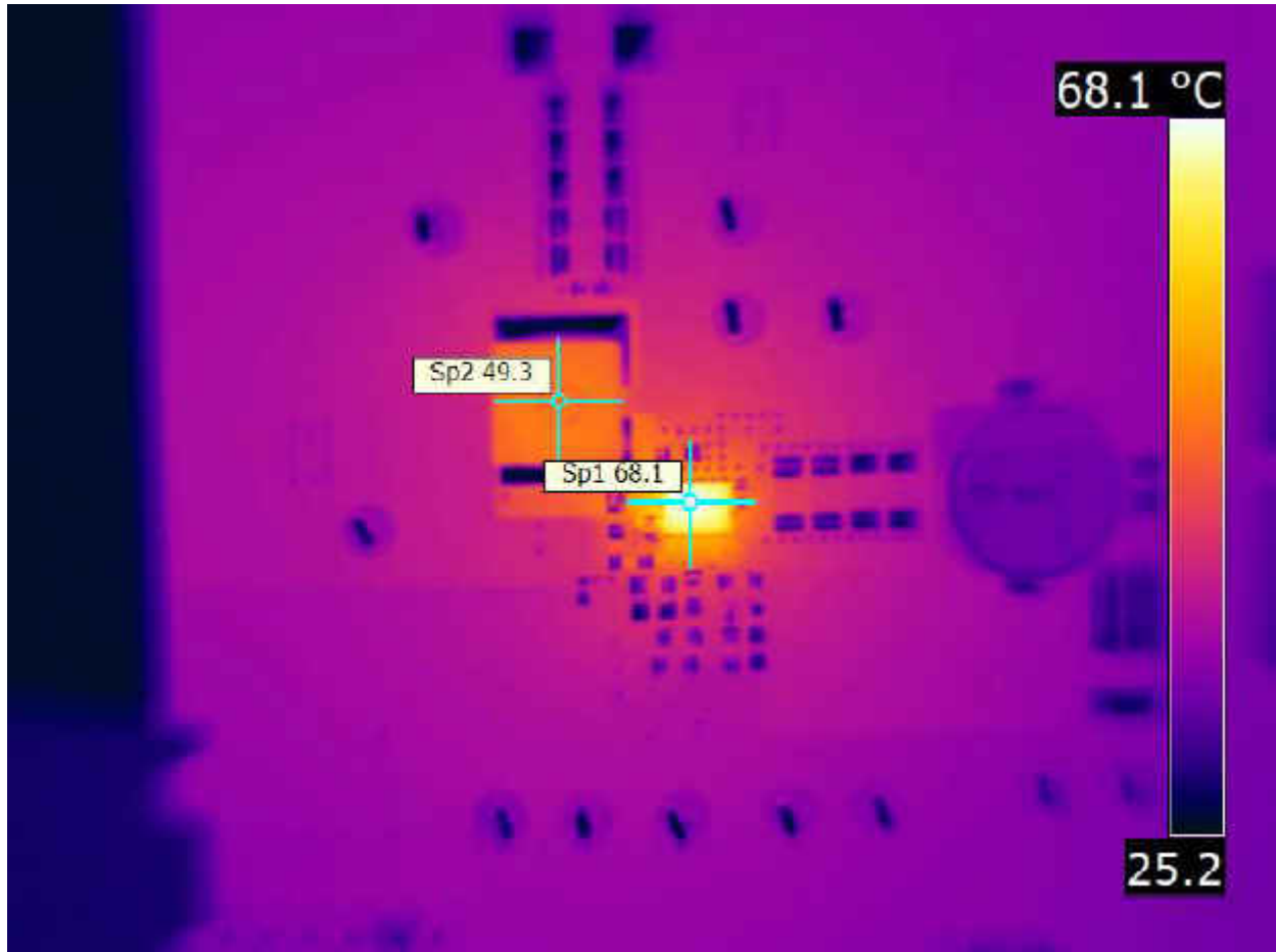
图 10-2. 25°C 环境温度下的热图像
