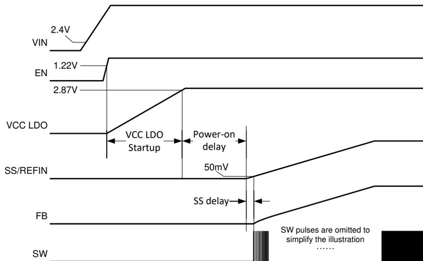
图 7-1. 使用内部 LDO 的内部上电序列
