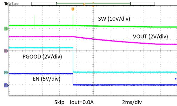
图 8-23. 使能预偏置断电，跳越
