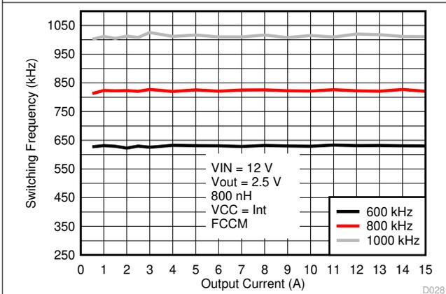
图 8-4. 开关频率与输出电流间的关系
