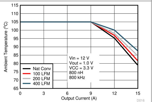
图 6-4. 安全工作区， $V_{OUT} = 1.0V$
