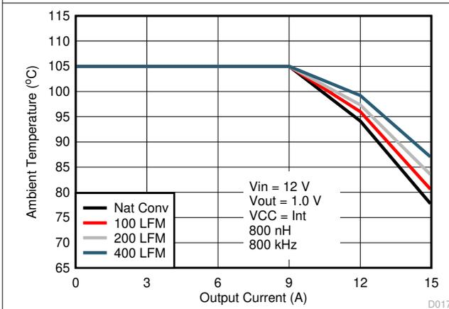
图 6-3. 安全工作区， $V_{OUT} = 1.0V$
