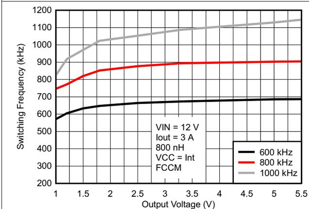
图 8-6. 开关频率与输出电压间的关系
