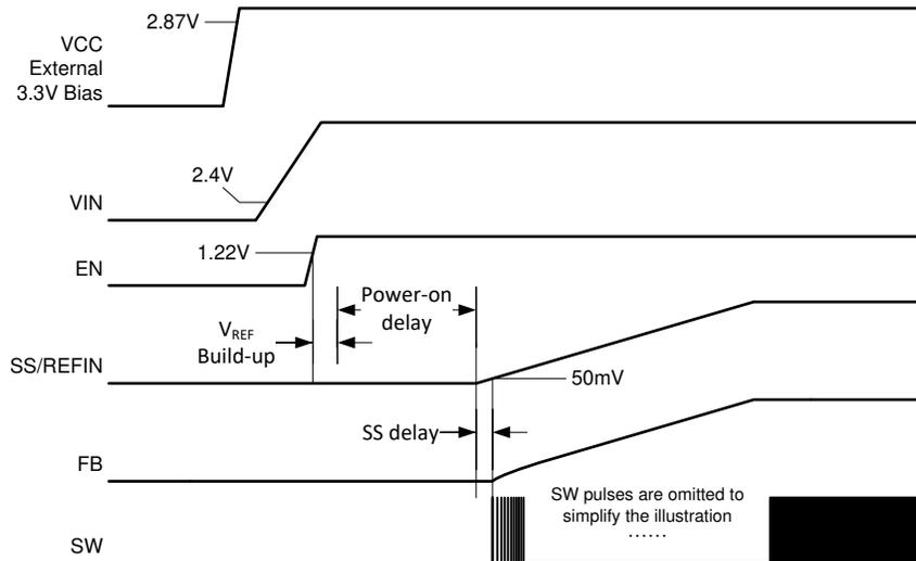
图 7-2. 使用外部偏置的内部上电序列
