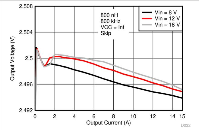
图 8-7. 输出电压与输出电流间的关系
