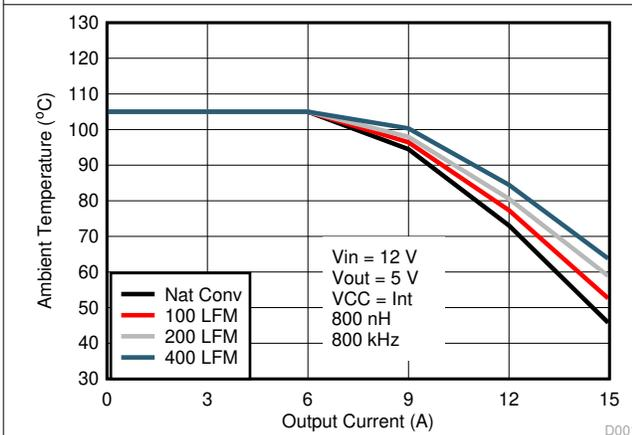
图 6-5. 安全工作区， $V_{OUT} = 5V$
