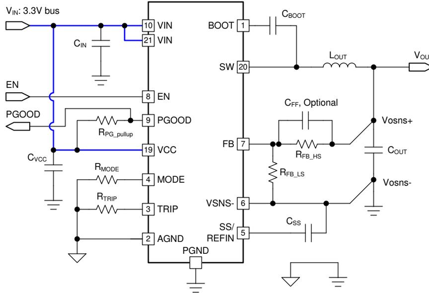
图 7-5. 具有 3.3V 总线的单 VIN 配置
