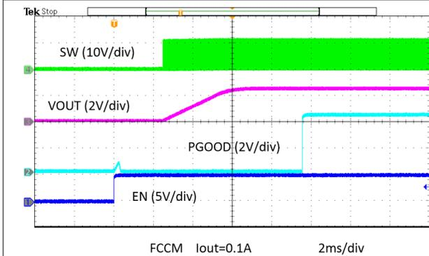
图 8-16. 使能上电，I<sub>out</sub> = 0.1A
