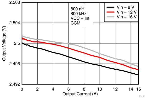
图 8-8. 输出电压与输出电流间的关系
