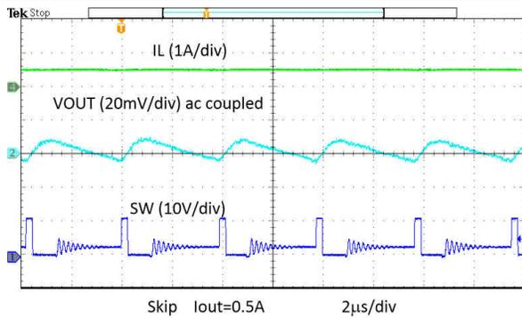
图 8-30. 输出电压纹波, 跳跃
