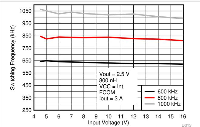
图 8-5. 开关频率与输入电压间的关系
