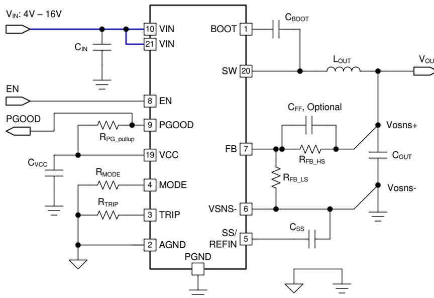
图 7-4. 具有 12V 总线的单  $V_{IN}$  配置
