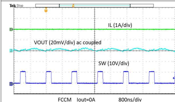
图 8-26. 输出电压纹波
