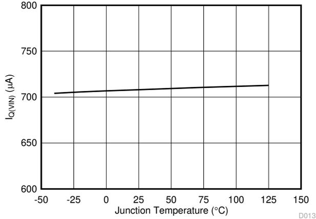
图 6-7.  $I_{Q(VIN)}$  与结温间的关系
