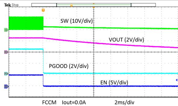
图 8-17. 使能断电，I<sub>out</sub> = 0A
