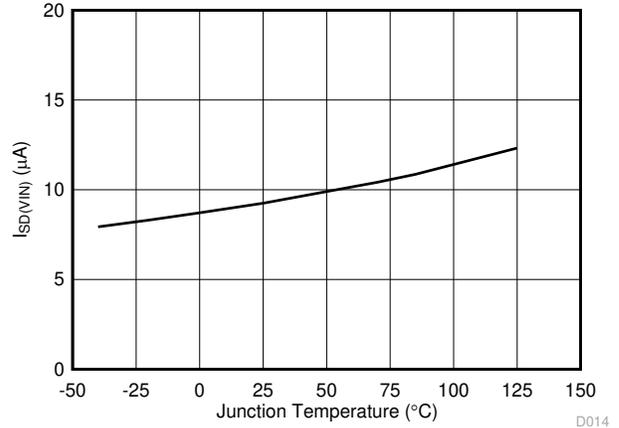
$V_{IN} = 12V$   $V_{EN} = 0V$  内部 VCC LDO
