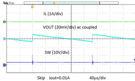
图 8-29. 输出电压纹波, 跳跃
