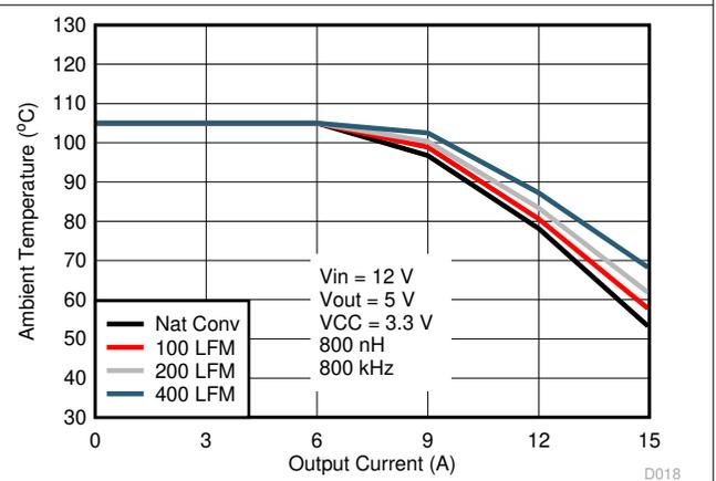
图 6-6. 安全工作区， $V_{OUT} = 5V$
