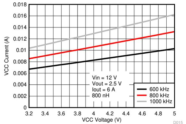
图 8-13. ICC 电流与外部 VCC 电压间的关系
