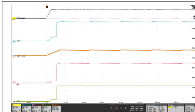
图 8-2. 低功耗路径的启动曲线 ( LPM = 低电平, V_{IN} = 48V , 无负载, CBST = 470nF )
