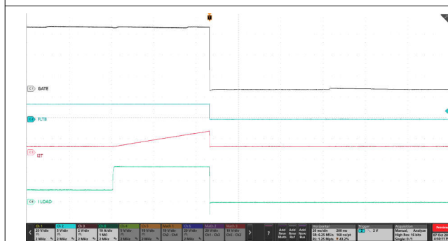
图 9-8. 6A 至 16A 负载阶跃下 TPS4812-Q1 EVM 基于 I²T 的过流响应
