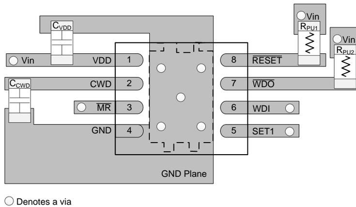
图 26. Typical Layout For TPS3852
