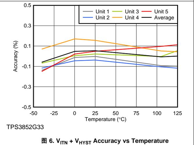
图 6. V<sub>ITN</sub> + V<sub>HYST</sub> Accuracy vs Temperature
