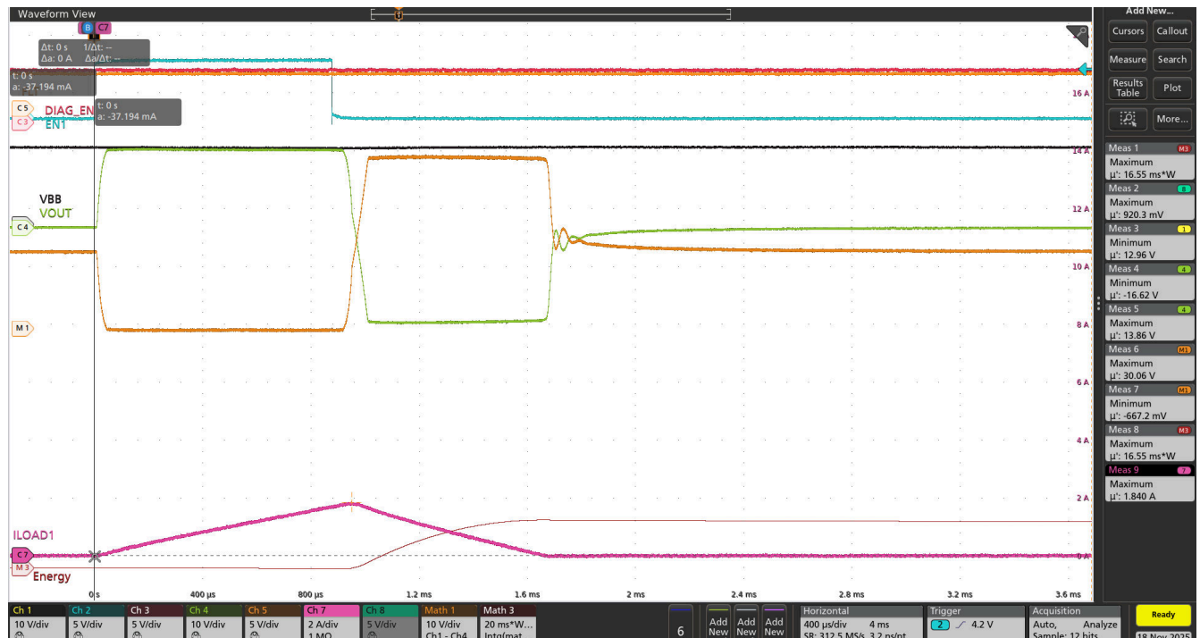
图 8-26. 5mH 电感负载驱动 ( VBB = 13.5V , T AMB = 125°C )
