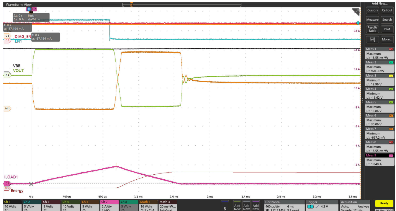
图 8-26. 5mH 电感负载驱动 ( V_{BB} = 13.5V , T_{AMB} = 125^{\circ}C )
