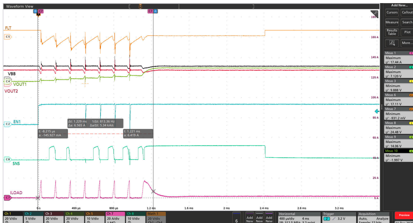
图 8-29. 使用 TPS2HC16-Q1 器件的通道 1 在 13.5V VBB、ILIM 引脚对地短路和 125°C 环境温度下实现 220uF 容性负载充电 (通道 2 上无负载)
