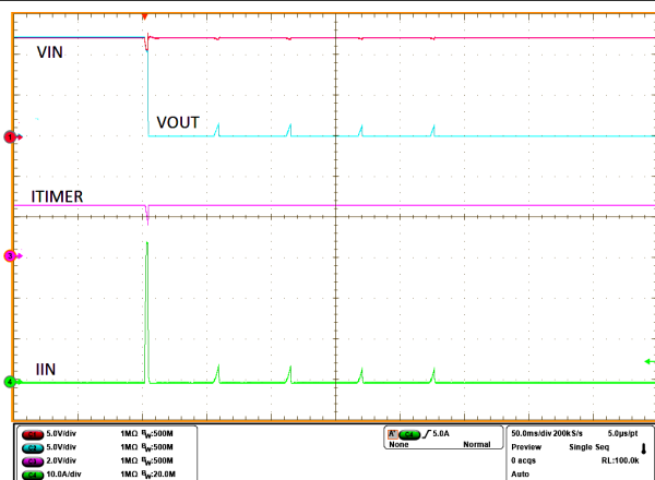
图 8-4. 热插拔启动，有输出负载，dVdt 受限
