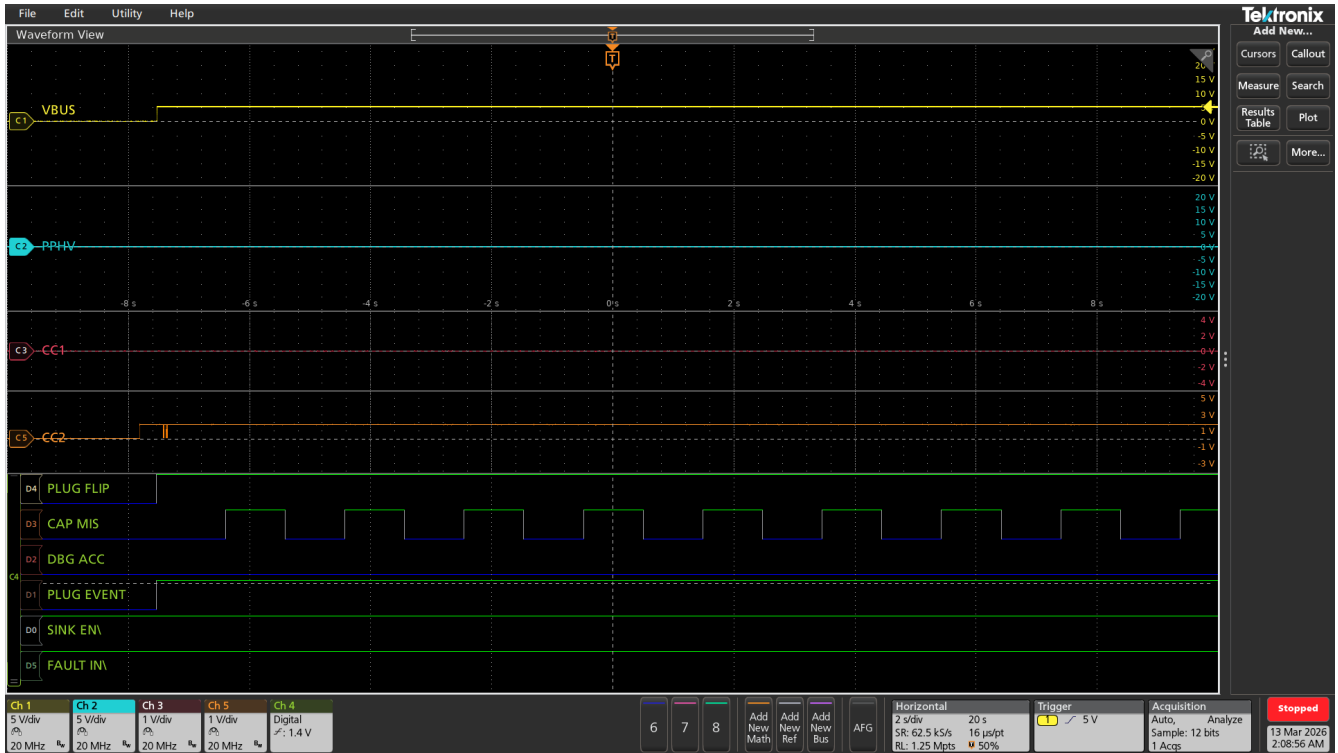
图 9-2. PD 合约 (能力不匹配且 PPHV 已禁用)
