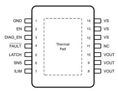
图 5-1. PWP Package, 14-Pin HTSSOP Top View
