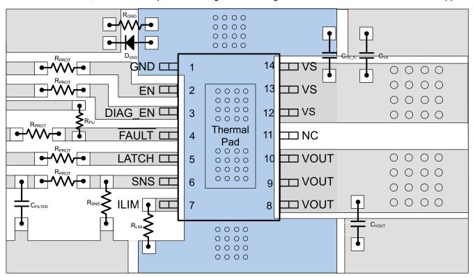
图 9-8. Layout With a GND Network
