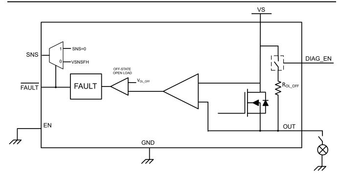
图 8-10. Open-Load Detection Circuit
