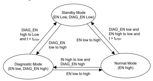
图 8-15. Work-Mode State Machine
