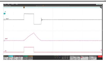
图 8-6. TPS1HTC30 Inductive Discharge (400 mH)
