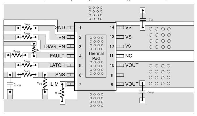
图 9-7. Layout Without a GND Network
