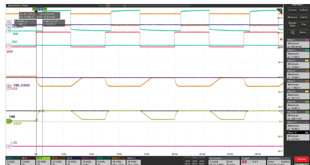
VBB = 13.5V V OUT = 开路负载 T AMB = 25°C DIAG_EN = PWM V EN1 = 0V (200Hz)
