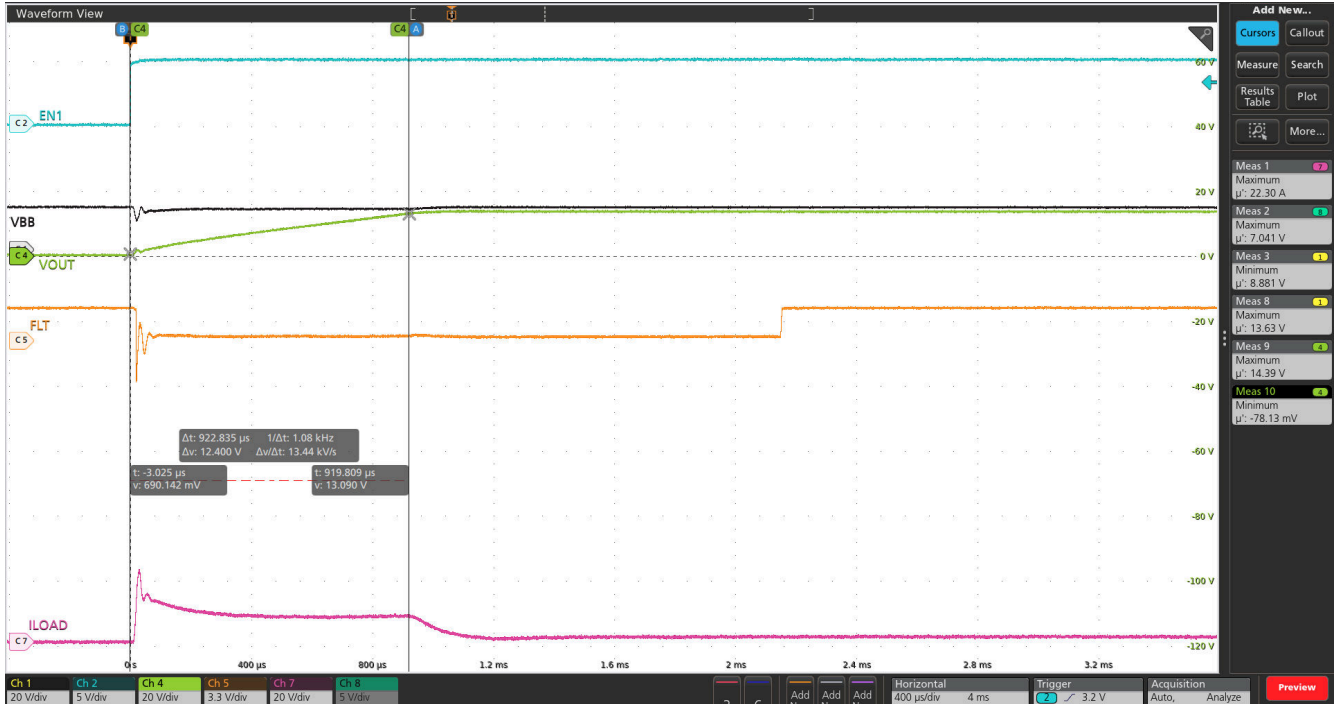
图 8-30. TPS1HC04-Q1 器件在 13.5V VBB、ILIM 引脚开路 and 125°C 环境温度下，进行 680uF 容性负载充电
