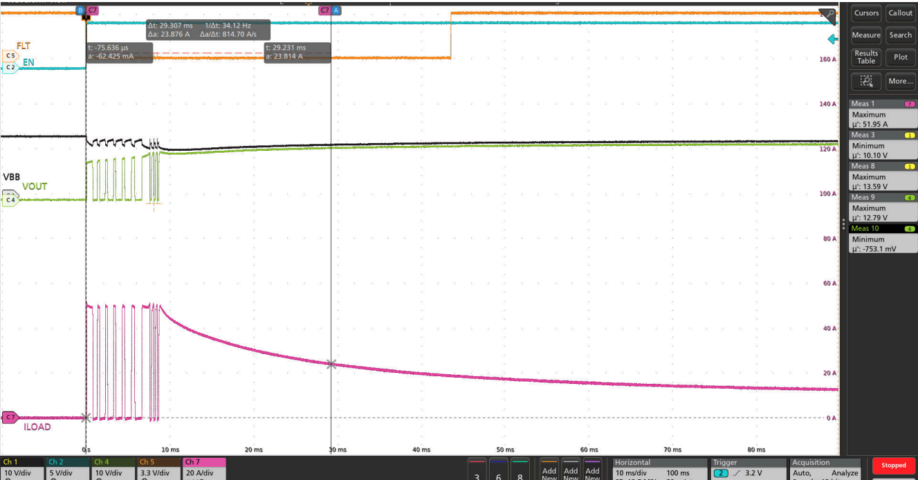
图 8-35. 使用 TPS1HC03-Q1 在 13.5V VBB 下进行 140W 灯泡充电 ( T_A(\text{device}) = 25^\circ\text{C} , T_A(\text{bulb}) = 25^\circ\text{C} , ILIM = GND )
