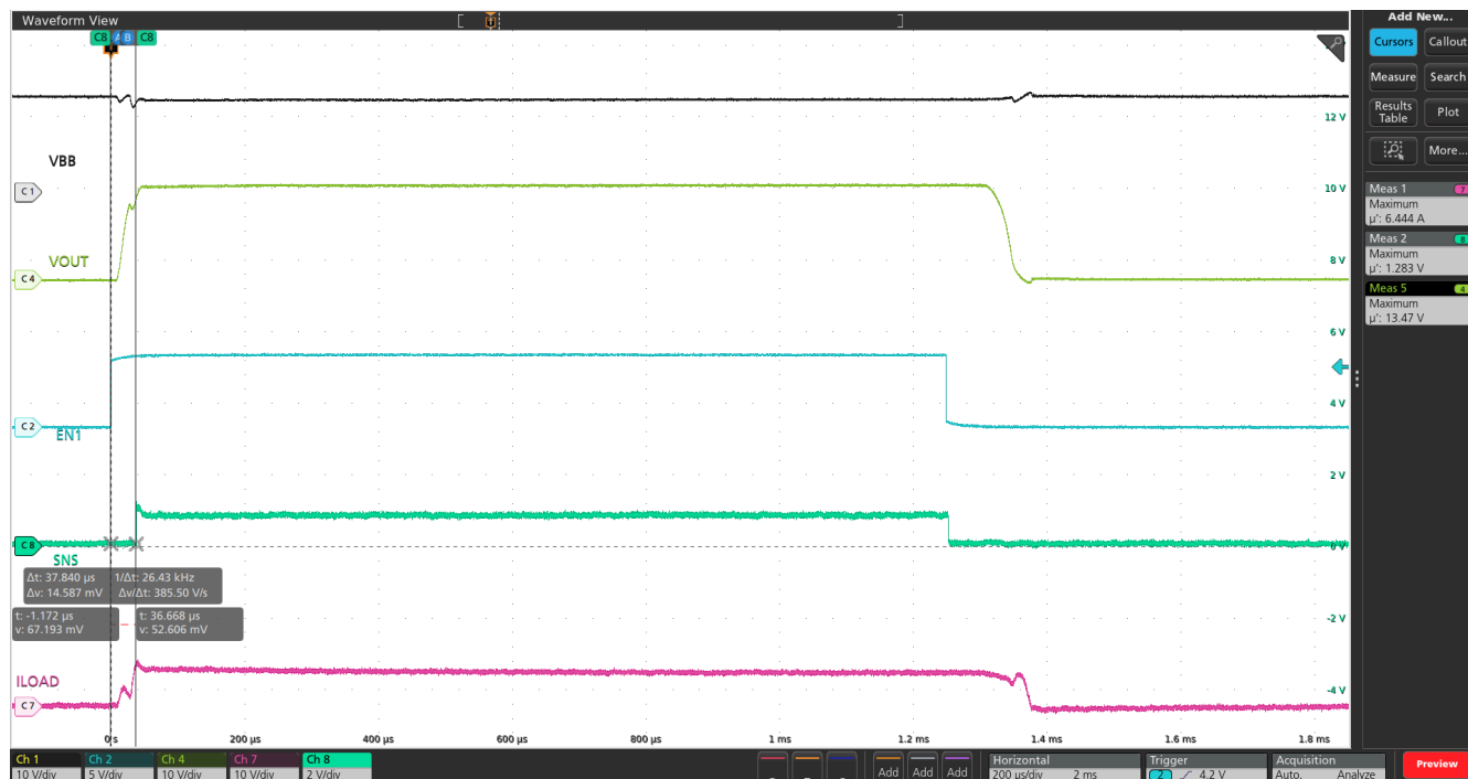
图 8-6. EN 触发的 SNS 响应时间 ( t_{SNSION3} )
