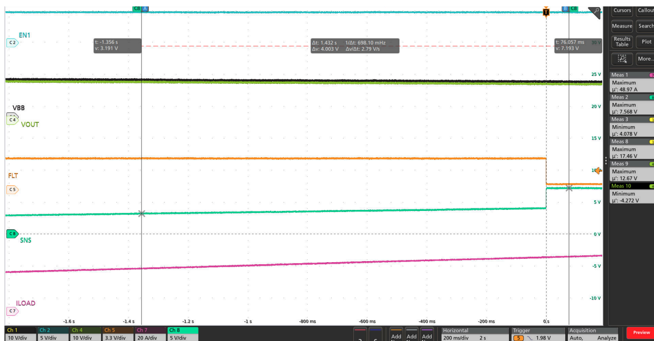
图 8-4. 负载电流变化时的 SNS 引脚电压( R_{SNS} = 1k\Omega )
