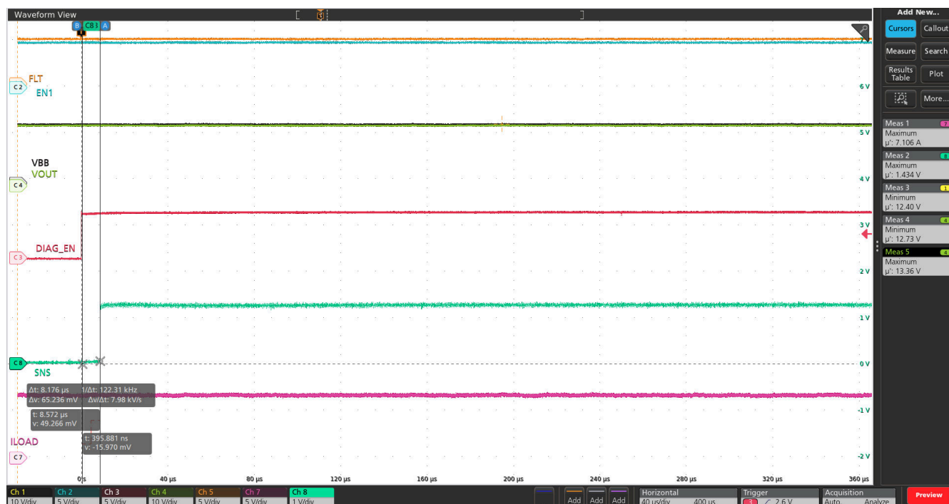
图 8-5. DIAG_EN 触发的 SNS 响应时间 ( t_{SNSION1} )
