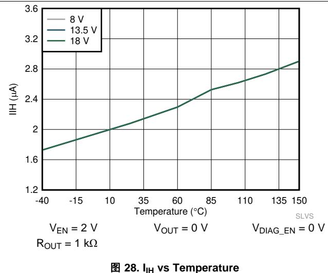
图 28.  $I_{IH}$  vs Temperature
