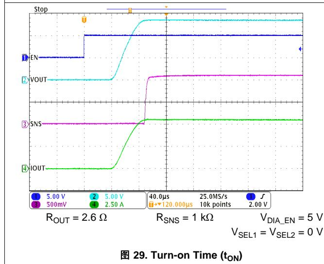
图 29. Turn-on Time ( $t_{ON}$ )
