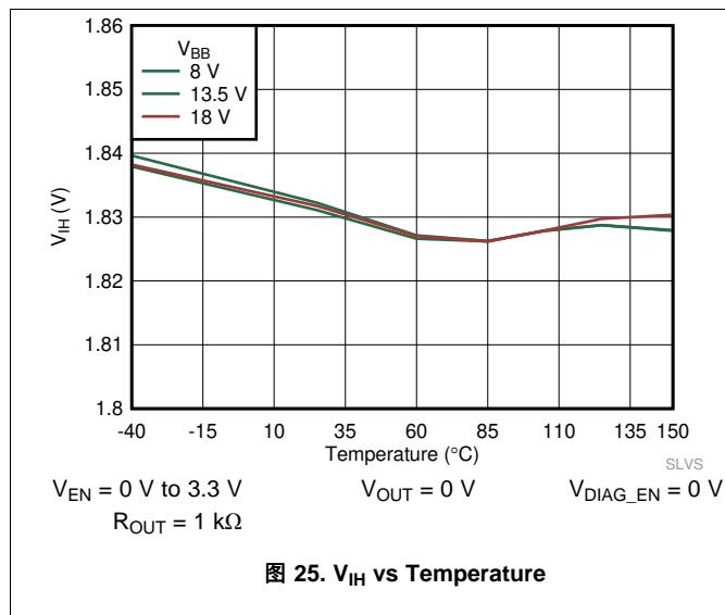
图 25.  $V_{IH}$  vs Temperature
