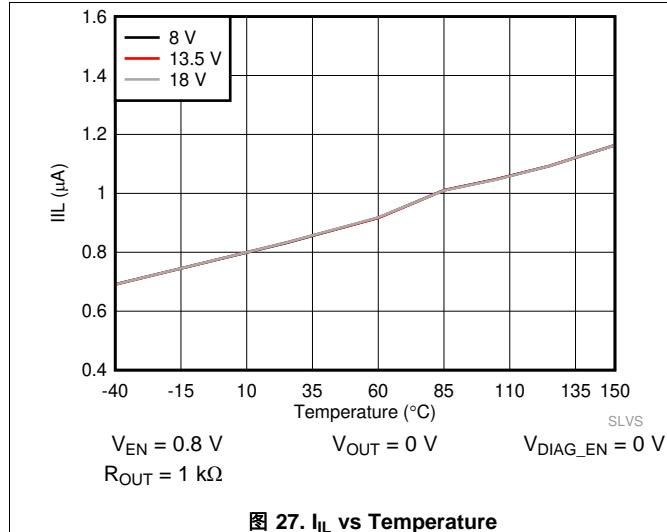
图 27.  $I_{IL}$  vs Temperature
