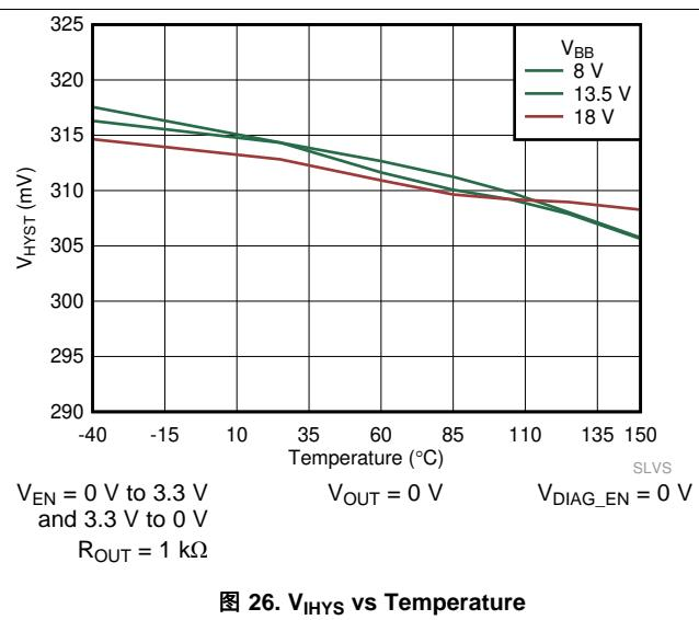
图 26.  $V_{IHYS}$  vs Temperature
