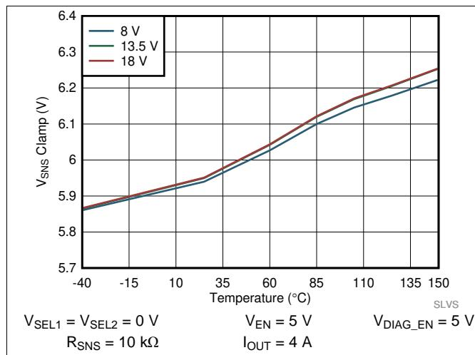
**图 21. Sense Pin Clamp Voltage (V<sub>SNSCLAMP</sub>) vs Temperature**
