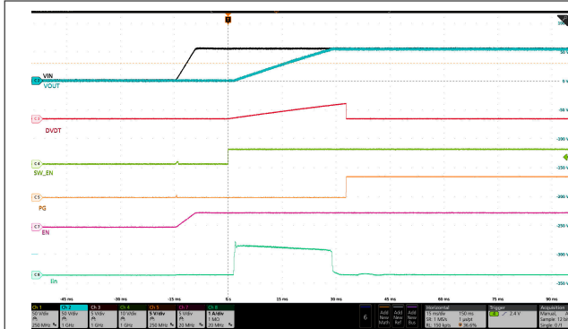
图 8-4. V_{IN} 从 0V 斜升至 54V
