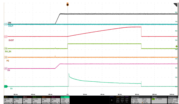
图 8-7. 上电至短路: V_{IN} = 54V , EN/UVLO 从 0V 升至 3V
