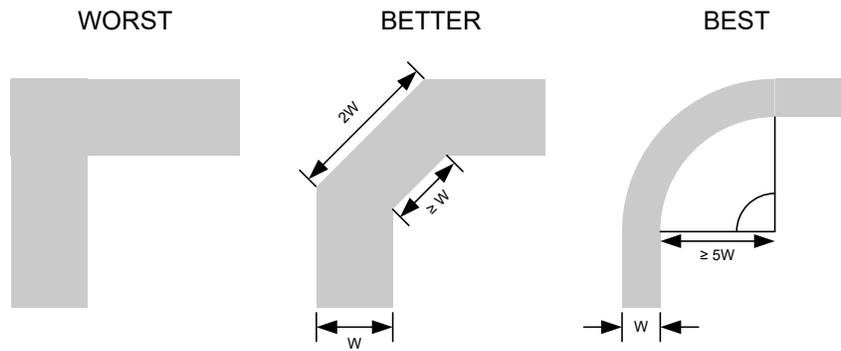
图 8-3. 可改善信号完整性的布线转角示例
