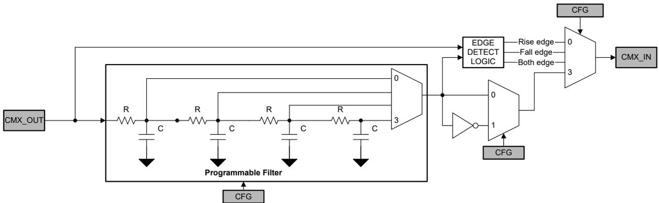
图 7-17. 可编程滤波器和边沿检测器方框图
