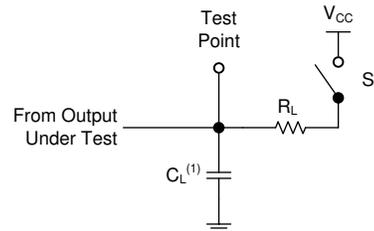
(1)  $C_L$  包括探头和测试夹具电容。
