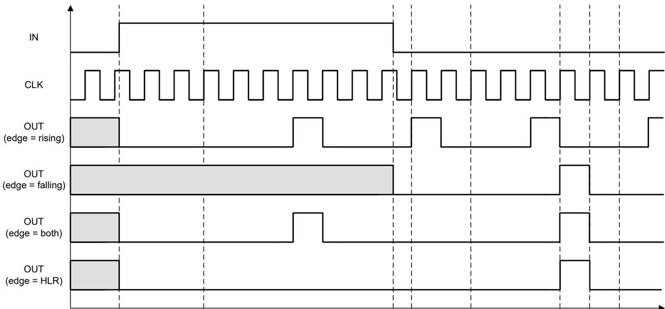
图 7-15. 计数器输出时序示例 (DATA = 3)
