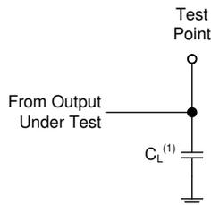
(1)  $C_L$  包括探头和测试夹具电容。
