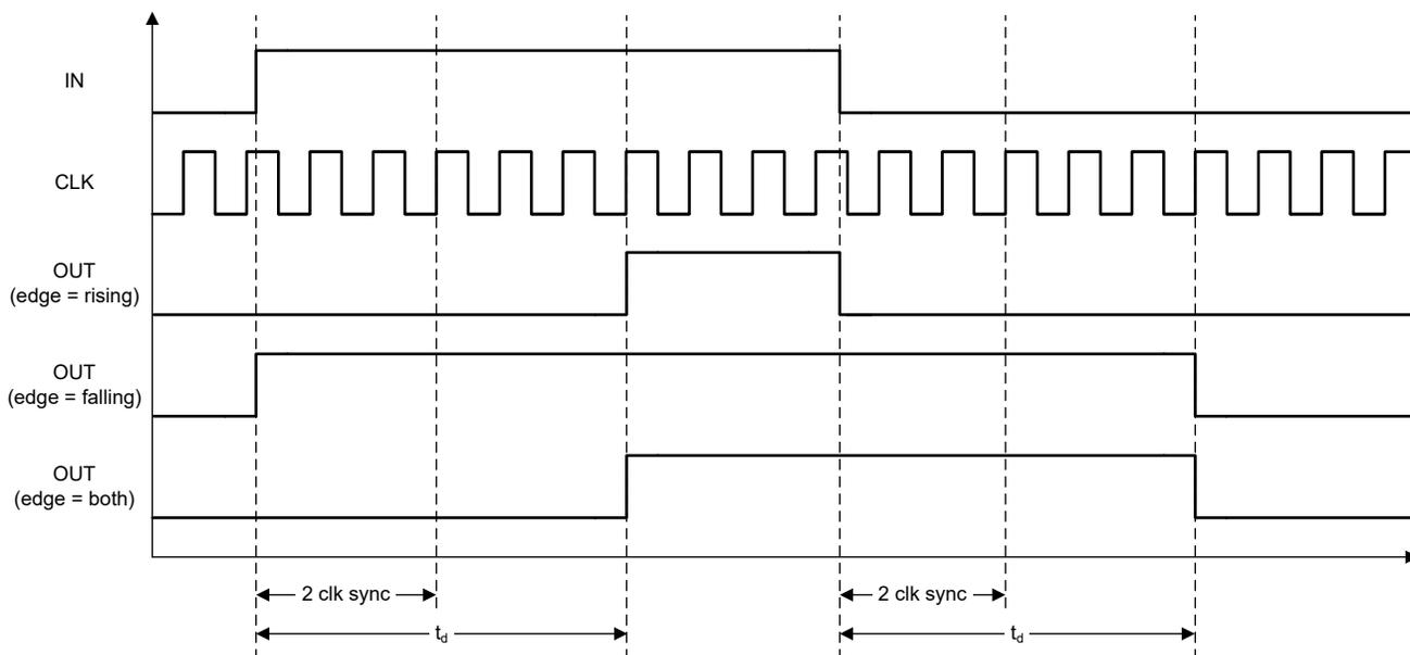
图 7-12. 延迟输出时序示例 (DATA = 3)
