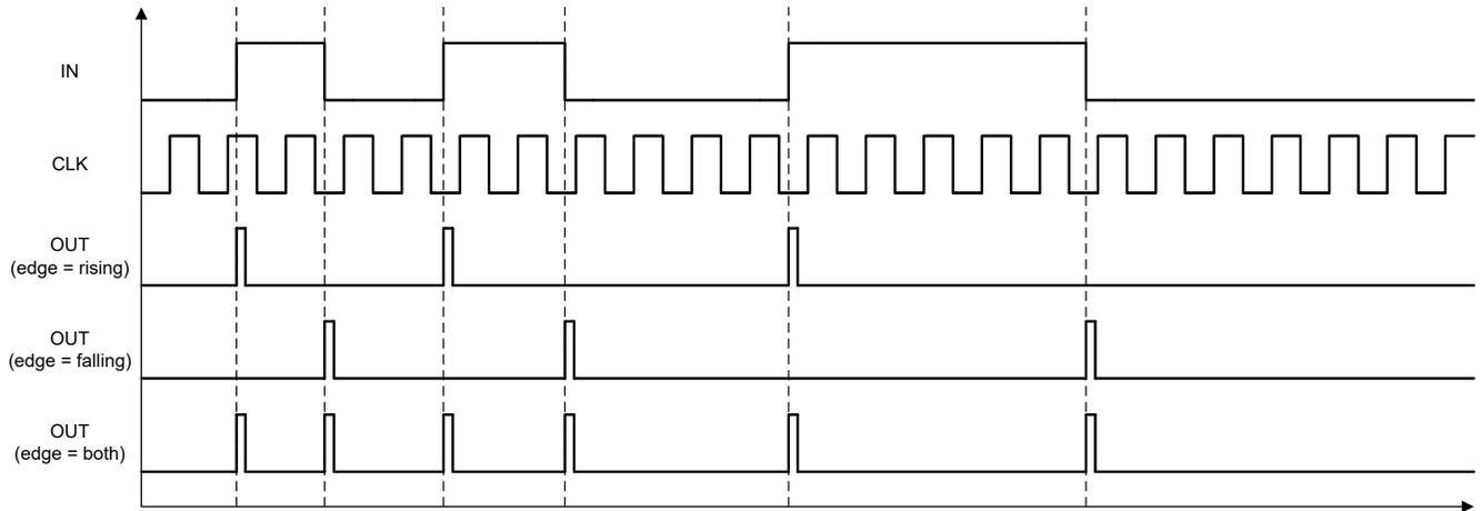
图 7-13. 边沿检测器输出时序示例
