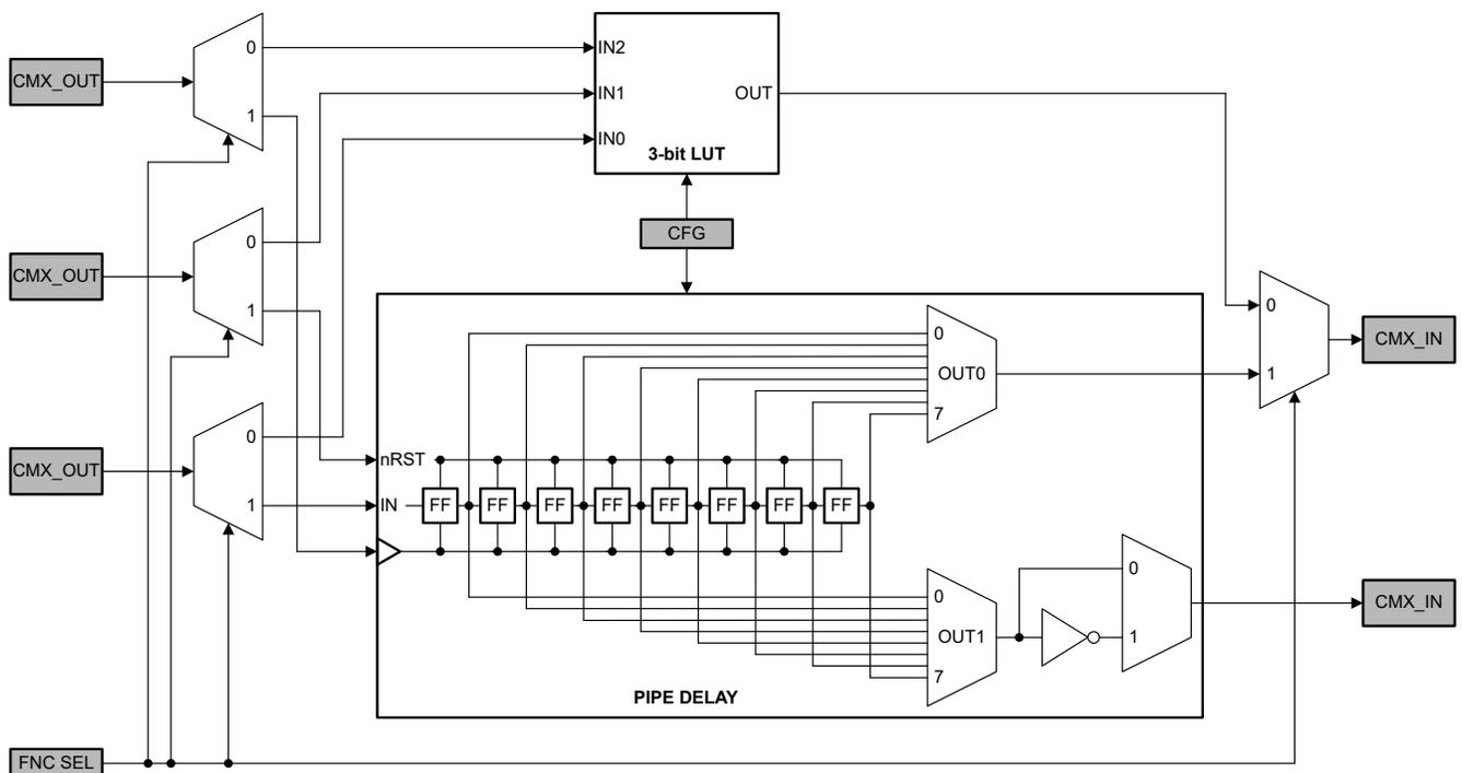
图 7-6. 3 位 LUT 或管道延迟方框图
