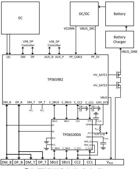
图 30. TPD6S300A Typical Application Diagram
