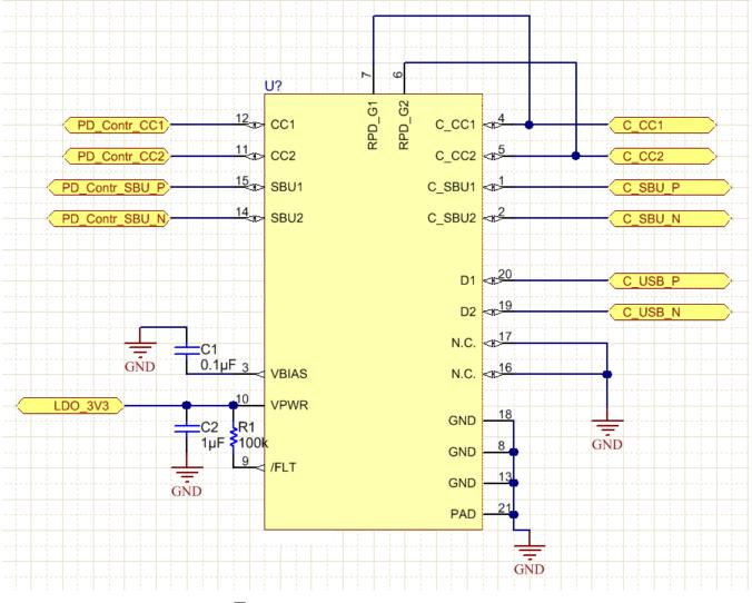
图 31. TPD6S300A Reference Schematic
