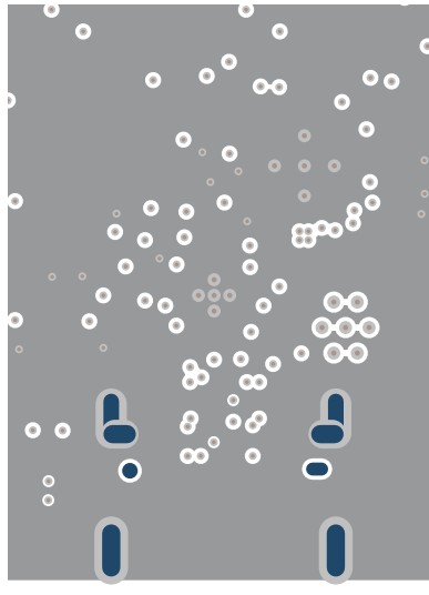
图 7-6. TPS26750 PCB 布局 - GND 层 2
