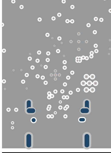
图 7-9. TPS26750 PCB 布局 - GND 层 5
