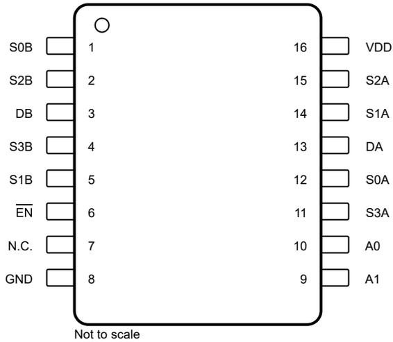
图 6-4. TMUX1309: PW Package, 16-Pin TSSOP (Top View)
