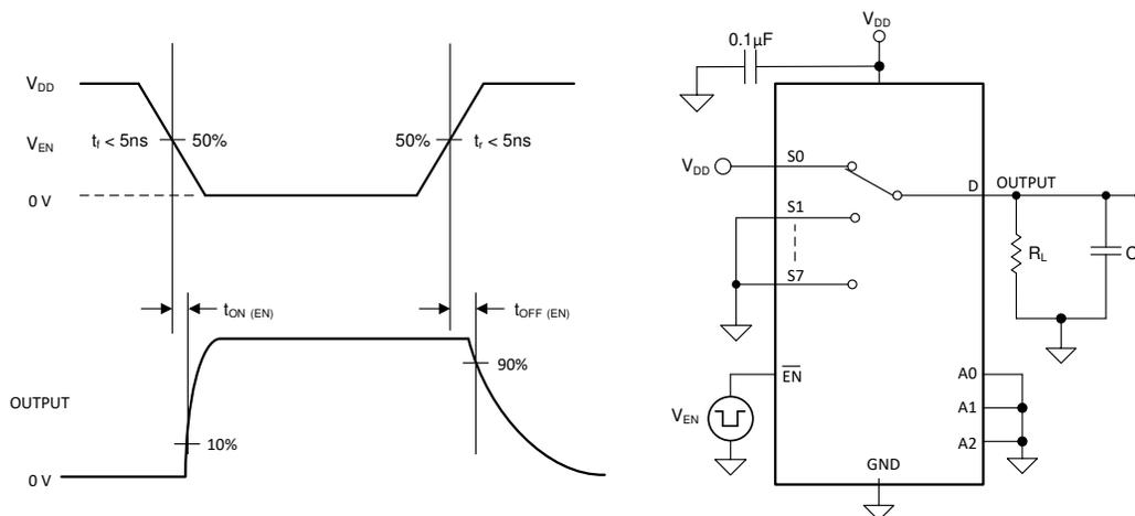
图 8-6. Turn-On and Turn-Off Time Measurement Setup
