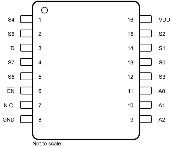
图 6-1. TMUX1308: PW Package, 16-Pin TSSOP (Top View)
