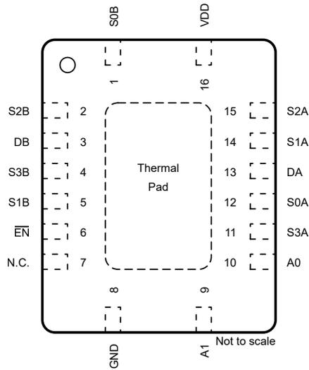
图 6-6. TMUX1309: BQB Package, 16-Pin WQFN (Top View)
