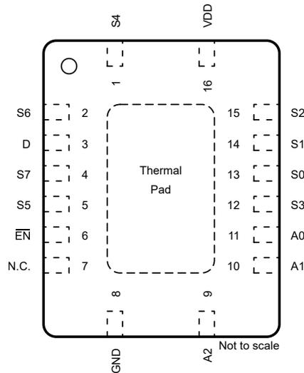
图 6-3. TMUX1308: BQB Package, 16-Pin WQFN (Top View)
