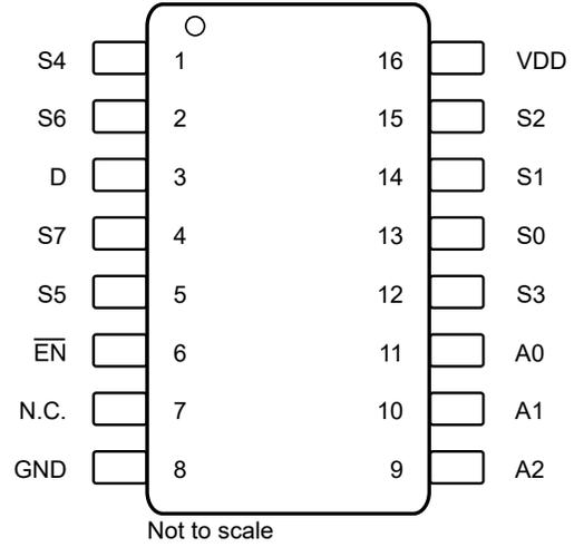
图 6-2. TMUX1308: DYY Package, 16-Pin SOT-23-THIN (Top View)
