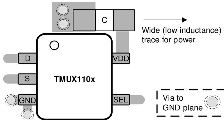
图 9-7. TMUX110x Layout Example
