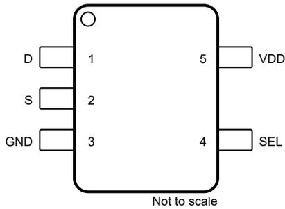
图 5-1. DCK Package 5-Pin SC70 (Top View)
