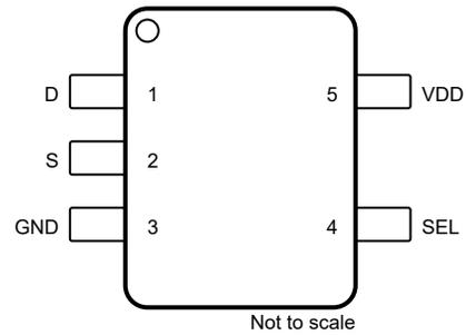
图 5-2. DBV Package 5-Pin SOT-23 (Top View)
