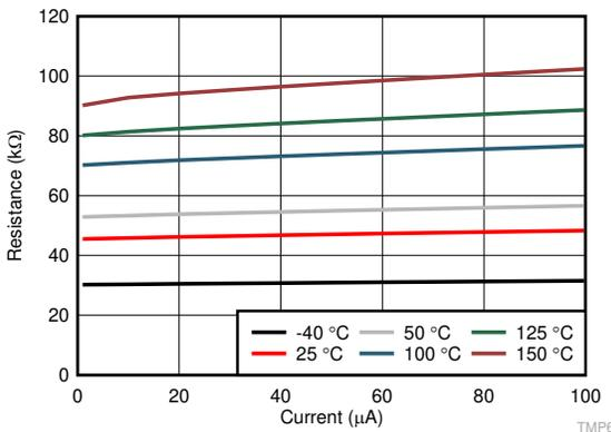
图 7-5. 电源相关电阻与偏置电流间的关系
