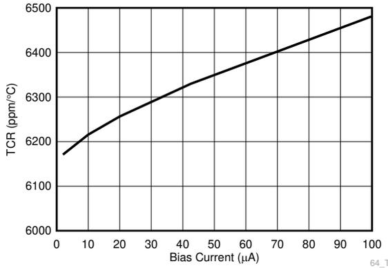
图 7-3. TCR 是感应电流  $I_{\text{SNS}}$  的函数
