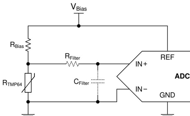
图 9-2. 带 ADC 的 TMP64-Q1 分压器
