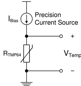
图 9-3. 带电流源的 TMP64-Q1 偏置电路
