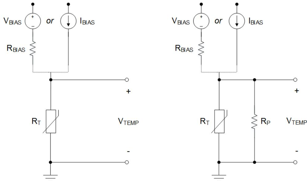
图 9-1. 线性热敏电阻 (左) 与非线性热敏电阻 (右) 的偏置电路实现
