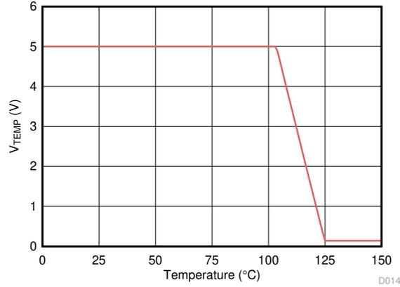
图 9-7. 热折返电压输出曲线
