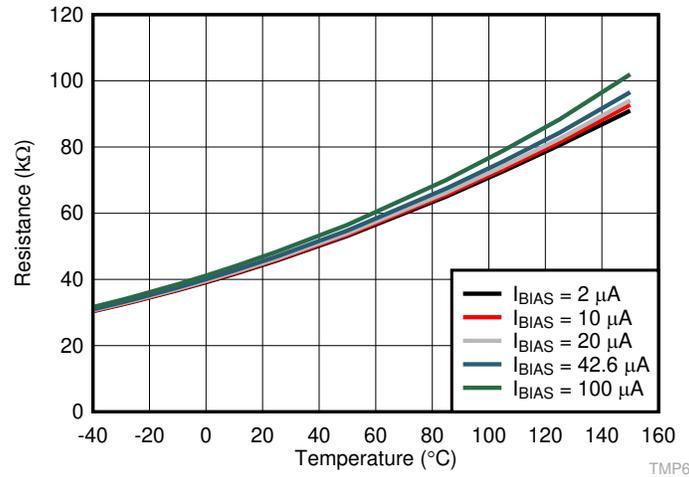
图 9-8. 带不同电流源的 TMP64-Q1 温度电压
