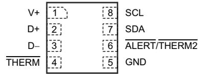
图 5-1. DQF Package 8-Pin WSON Top View
