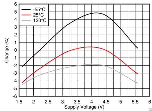
图 5-4. 采样周期变化与电源电压间的关系
