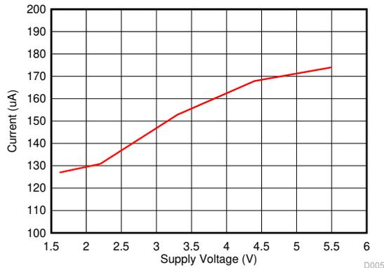
图 5-5. 转换电流与电源电压间的关系
