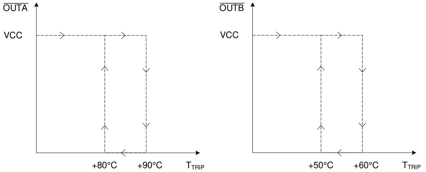
图 7-4. 具有迟滞功能的 TMP392 输出响应
