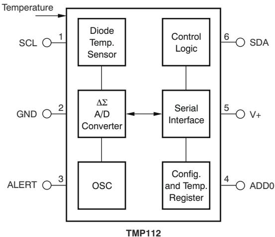
图 7-1. 内部方框图 ( SOT563-6 封装 )
