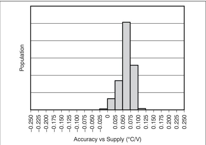
图 6-3. 精度与电源间的关系
