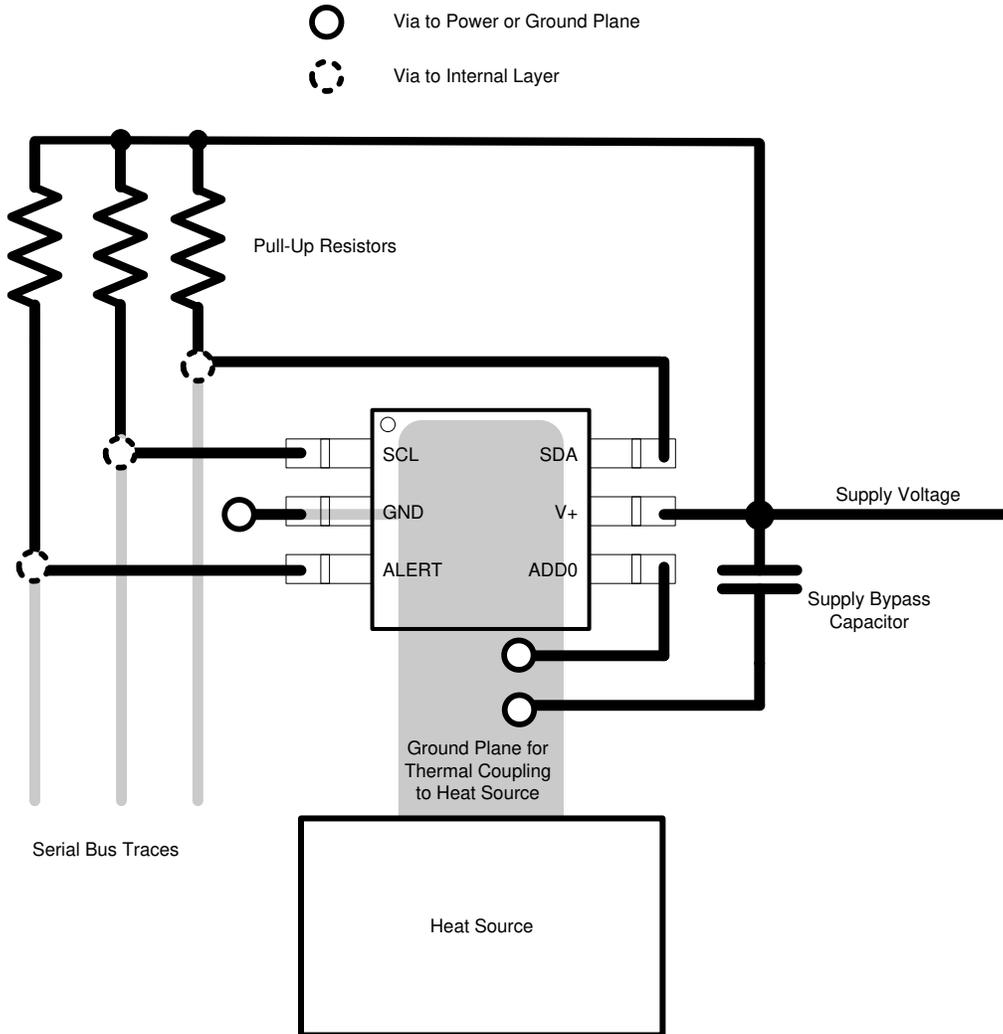
图 8-5. 布局示例 ( SOT563-6 封装 )
