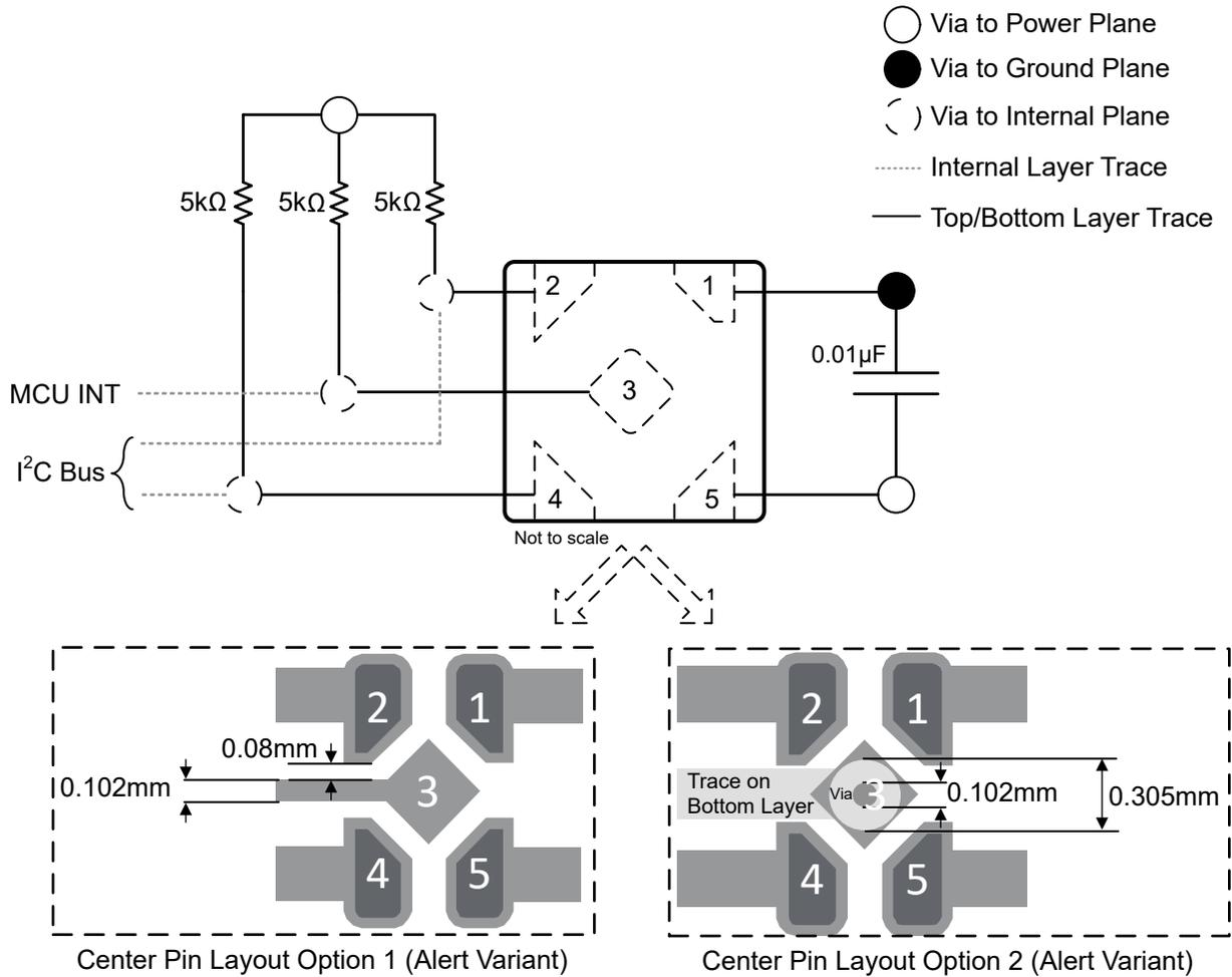
图 8-7. ALERT 引脚布局示例 ( X2SON-5 封装 )
