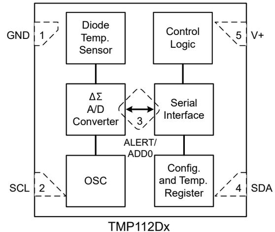
图 7-2. 内部方框图 ( X2SON-5 封装 )
