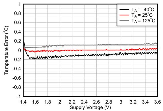
图 6-10. 温度误差与电源电压间的关系
