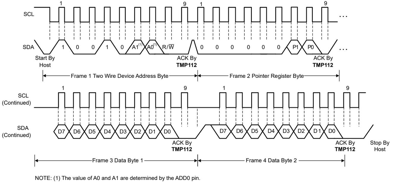
图 7-4. 针对写入字格式的两线制时序图
