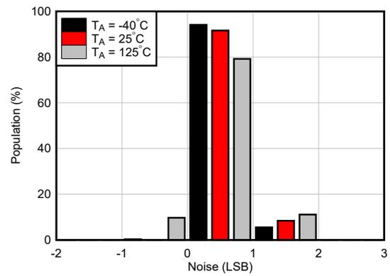
图 6-22. 噪声直方图 (油浴测量)
