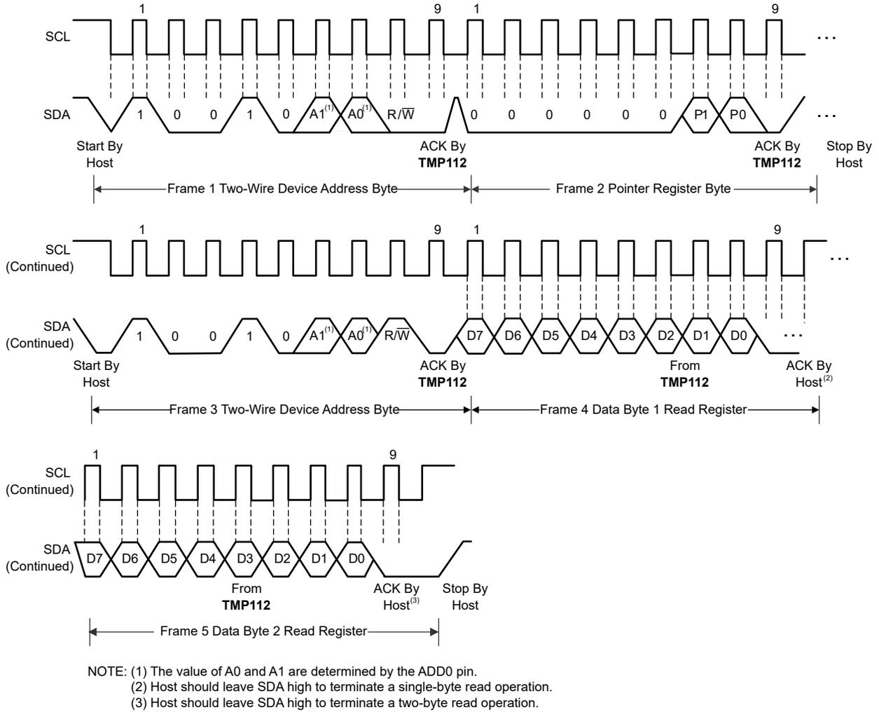
图 7-5. 针对读取字格式的两线制时序图
