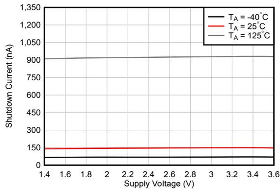
图 6-11. 关断电流与电源电压间的关系
