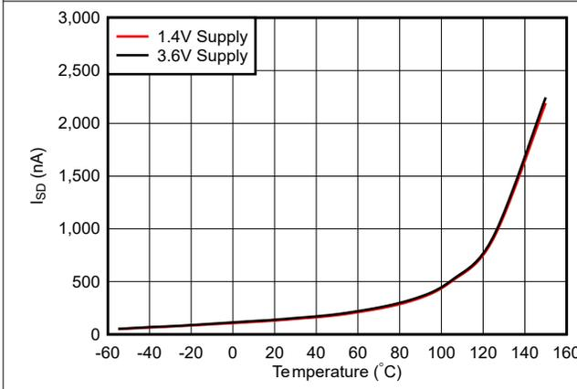
图 6-6. 关断电流与温度间的关系
