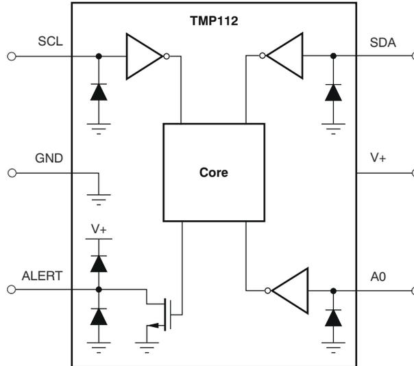
图 7-3. 等效内部 ESD 电路 ( SOT563-6 封装 )
