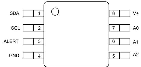
图 7-2. DGK Package 8-Pin VSSOP Top View
