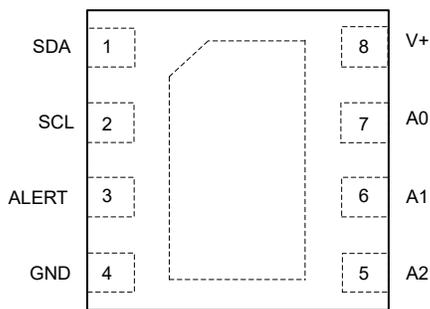
图 7-3. DSG Package 8-Pin WSON Top View
