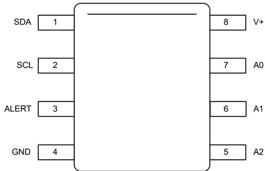
图 7-1. D Package 8-Pin SOIC Top View
