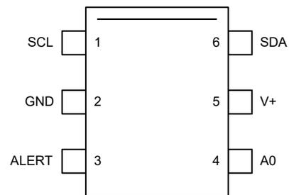
图 7-4. DRL Package 6-Pin SOT563 Top View
