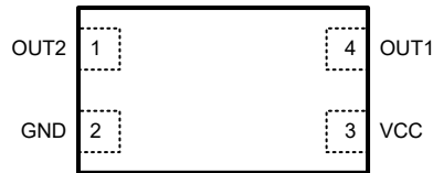
图 5-2. ZFC 封装，4 引脚 X1LGA ( 顶视图 )
