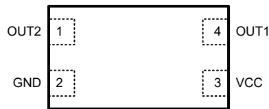
图 5-2. ZFC 封装，4 引脚 X1LGA ( 顶视图 )
