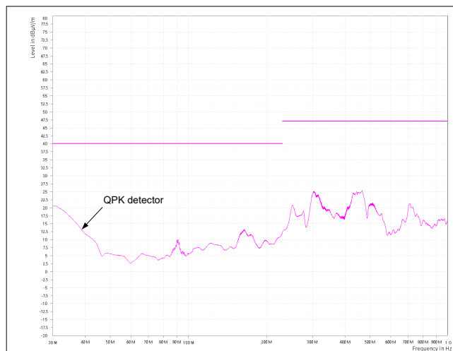
图 9-8. 符合 CISPR 32 B 类辐射发射限制：水平极化
