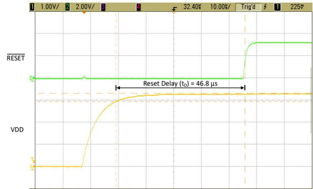
图 8-4. TLV841EVM RESET 延时时间 ( $t_D$ )
