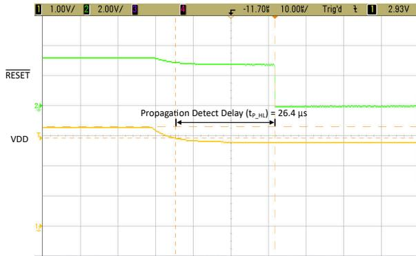
图 8-3. TLV841EVM 传播延迟的延时时间 ( $t_{D\_HL}$ )
