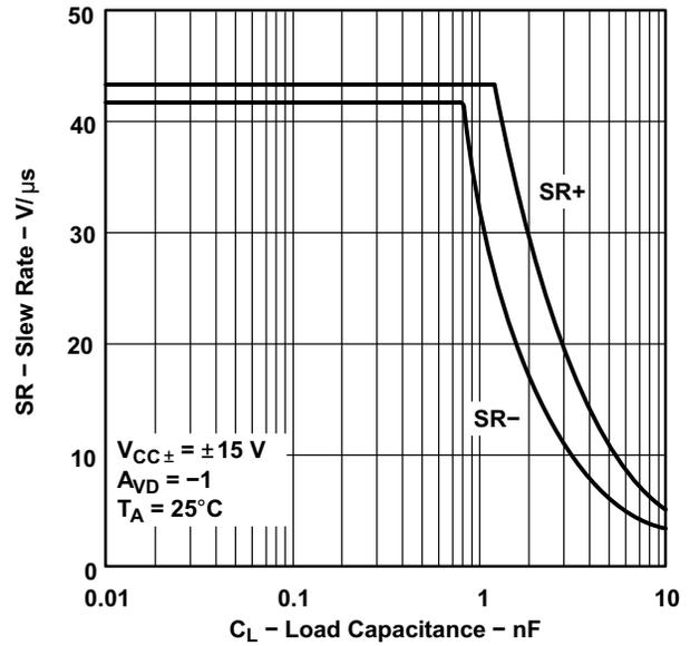
图 5-30. 压摆率与负载电容间的关系
