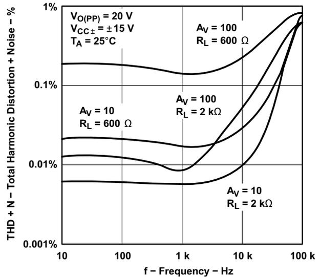
图 5-28. 总谐波失真加噪声与频率间的关系
