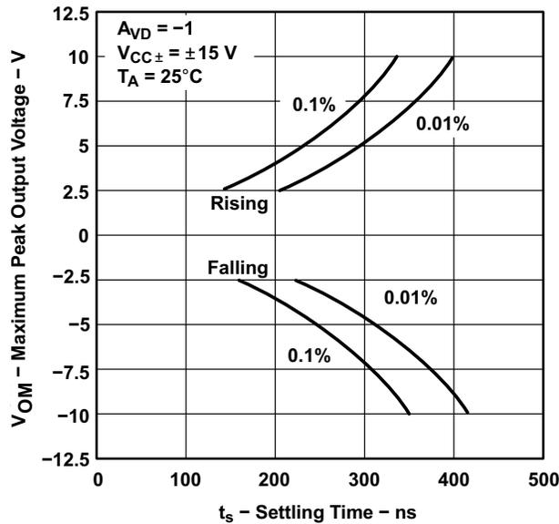
图 5-11. 最大峰值输出电压与稳定时间之间的关系
