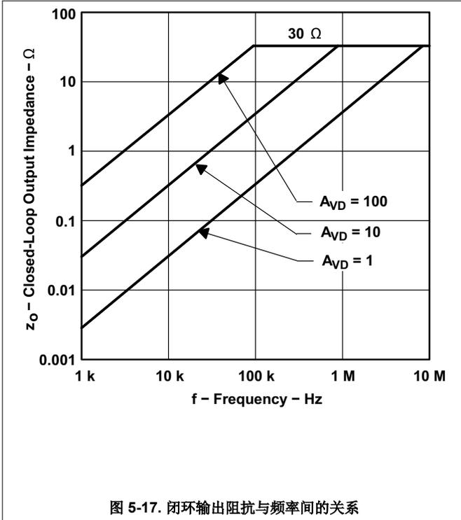
图 5-17. 闭环输出阻抗与频率间的关系
