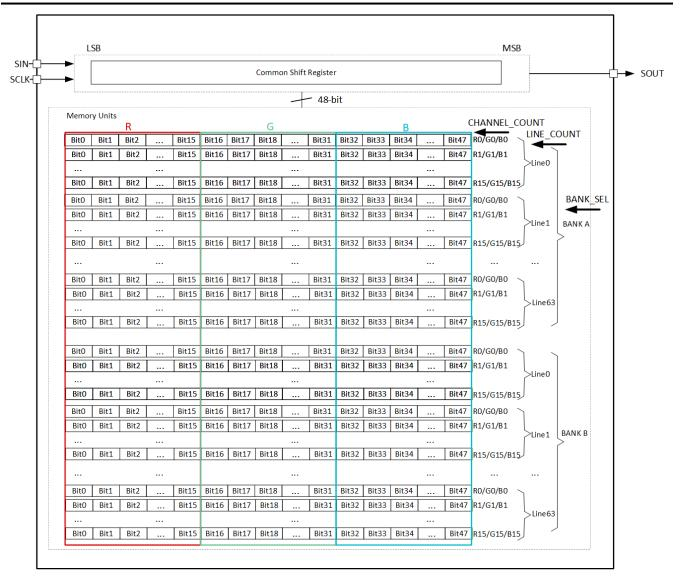
图 8-27. TLC6984 Memory-unit Structure
