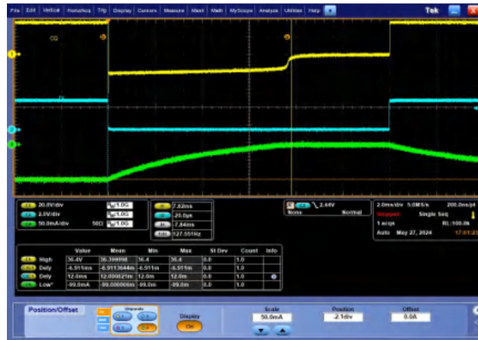
图 8-5. CQ 上电延迟、 t_{(UVLO)} (引脚模式或 SPI 模式下的默认 00b 设置)
