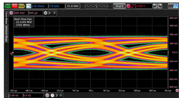
图 9-6. 12 Gbps Input Eye at TTP2 After Pre-channel
