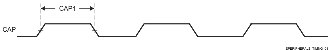
图 6-46. eCAP 输入时序
