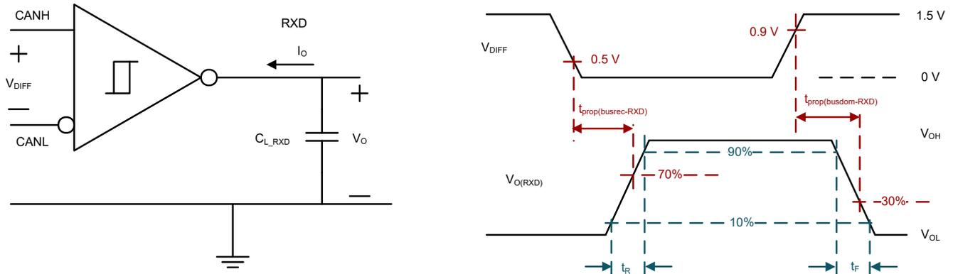
图 6-5. 接收器测试电路与测量
