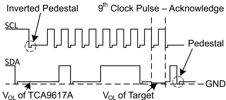
图 6-2. Bus B (2.2V to 5.5V Bus) Waveform
