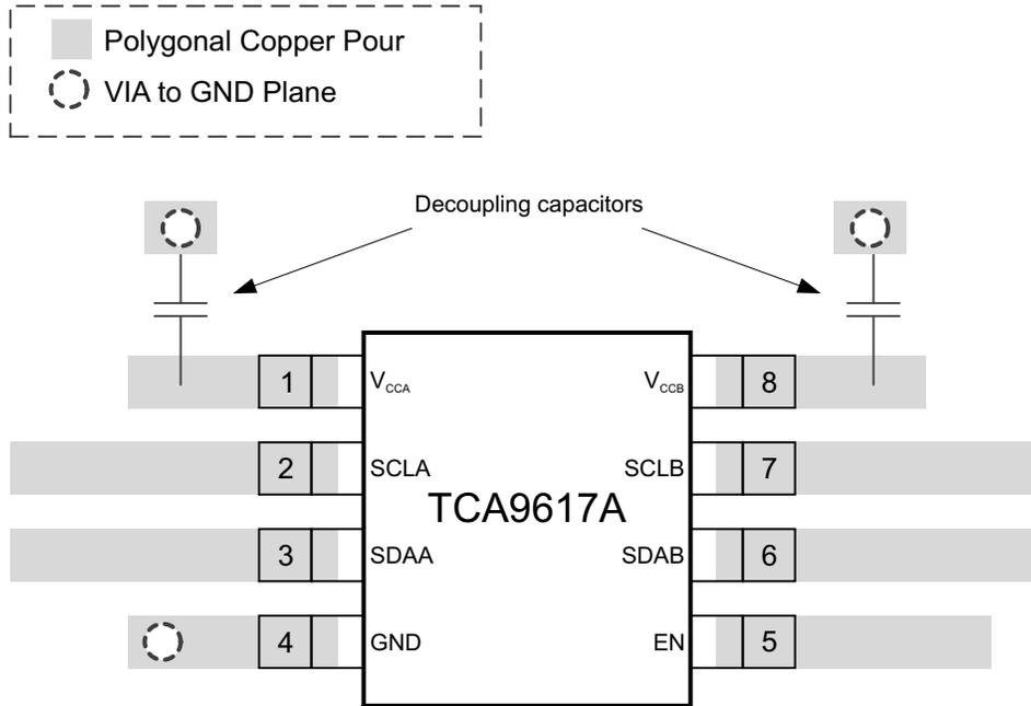
图 7-6. Layout Schematic
