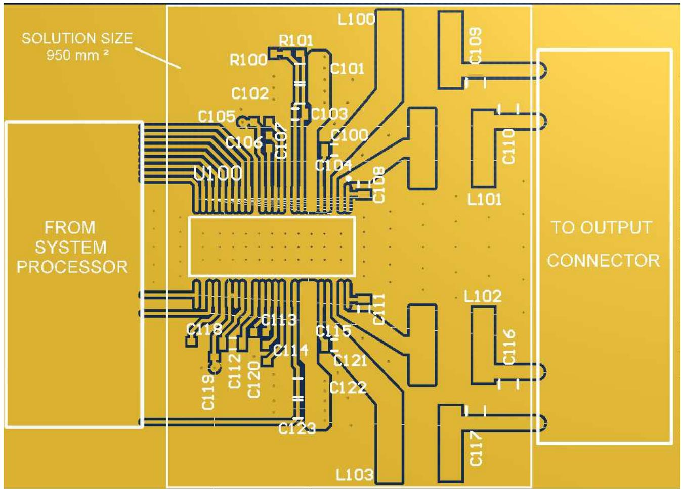
图 89. 2.0 (Stereo BTL) Top Copper View
