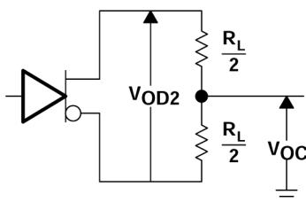
图 6-1. Driver Test Circuit,  $V_{OD}$  and  $V_{OC}$
