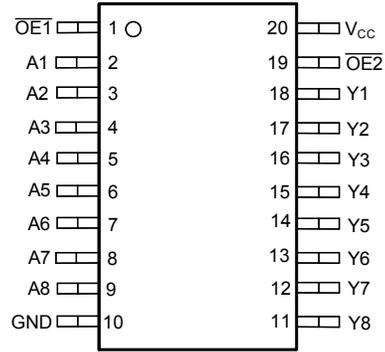
图 4-2. SN74LVC9541A PW、DGS 封装 (顶视图)
