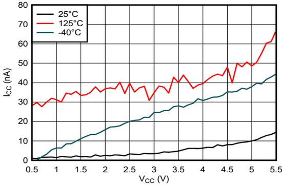
图 5-1. 电源电压两端的电源电流
