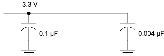
图 9-2. 建议的 M-LVDS 旁路电容器布局
