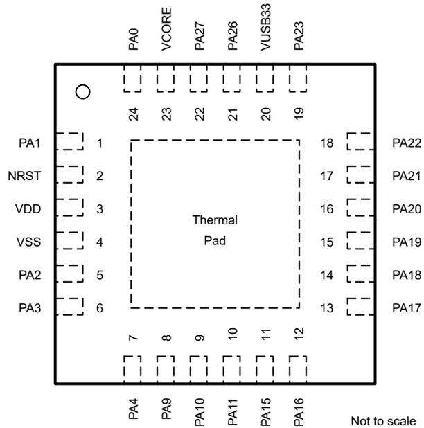
图 6-7. 24 引脚 RGE (0.5mm) (VQFN) 封装图
