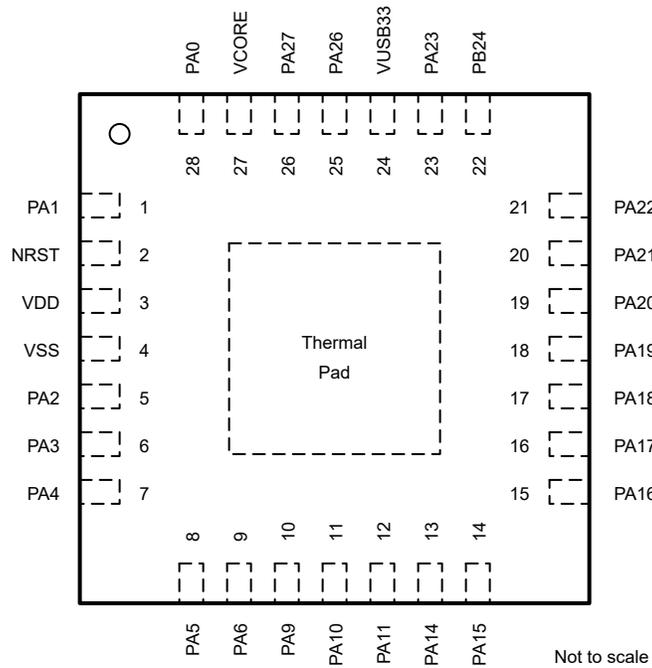
图 6-5. 28 引脚 RUY (0.5mm) (WQFN) 封装图
