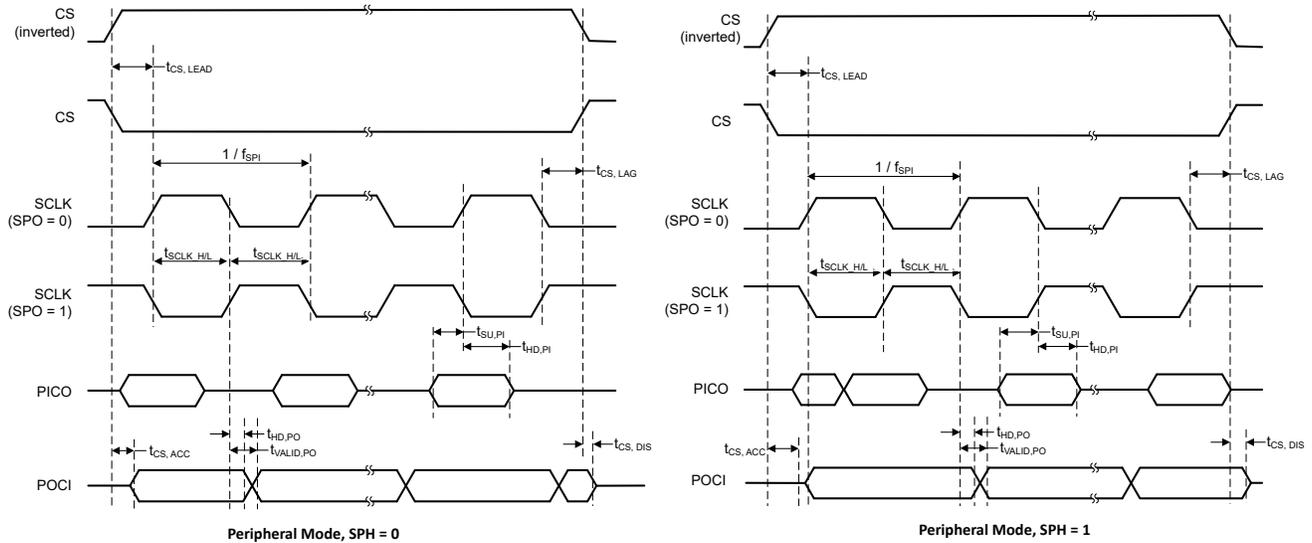
**图 7-5. SPI 时序图 - 外设模式**
