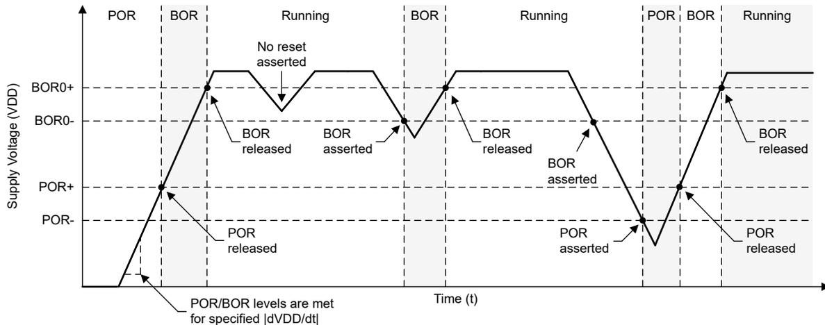
图 7-1. 下电上电 POR/BOR 条件 - VDD
