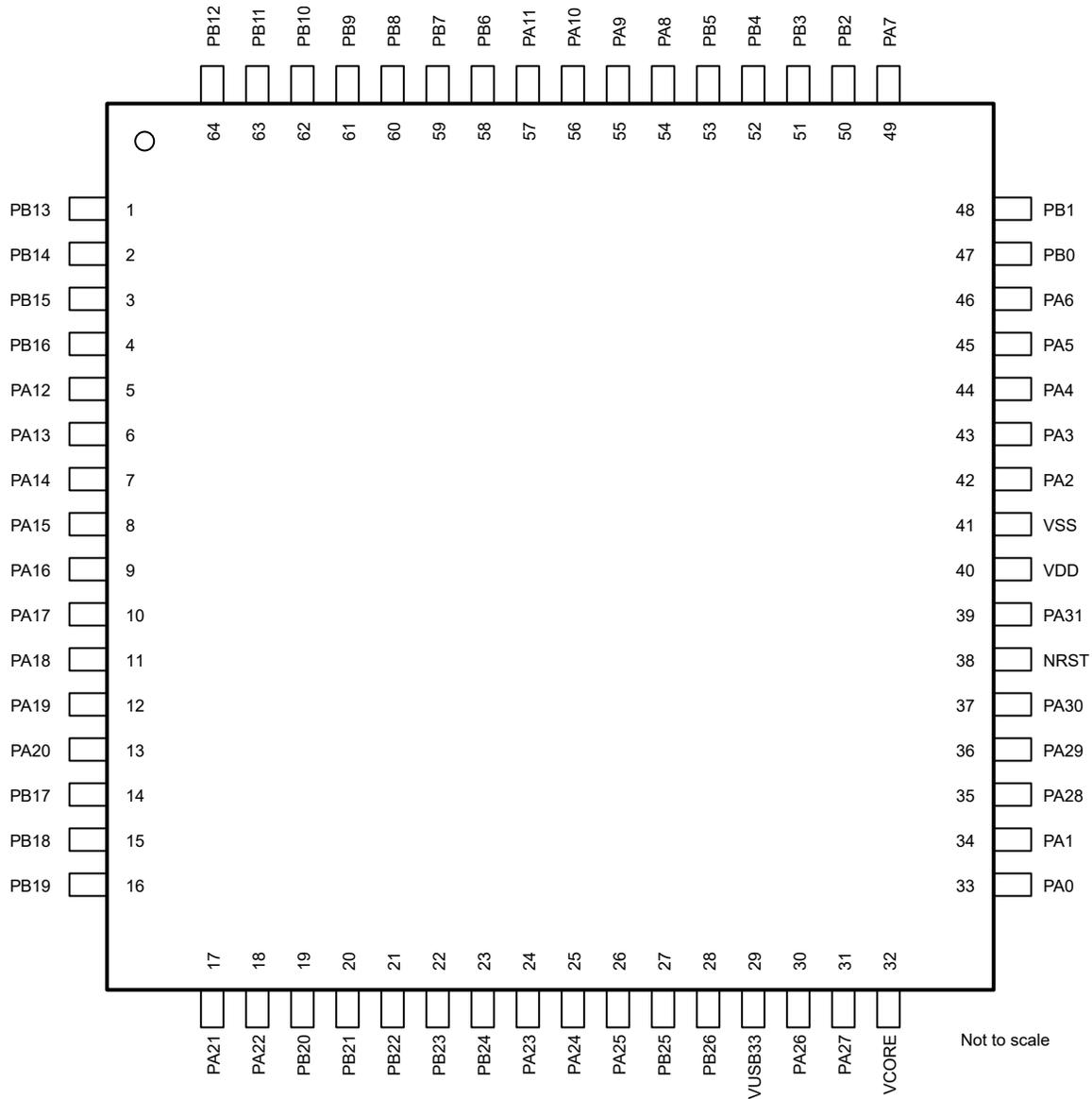
图 6-1. 64 引脚 PM (0.5mm) (LQFP) 封装图
