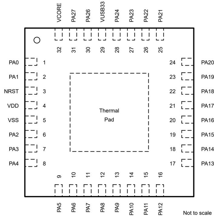
图 6-4. 32 引脚 RHB (0.5mm) (VQFN) 封装图
