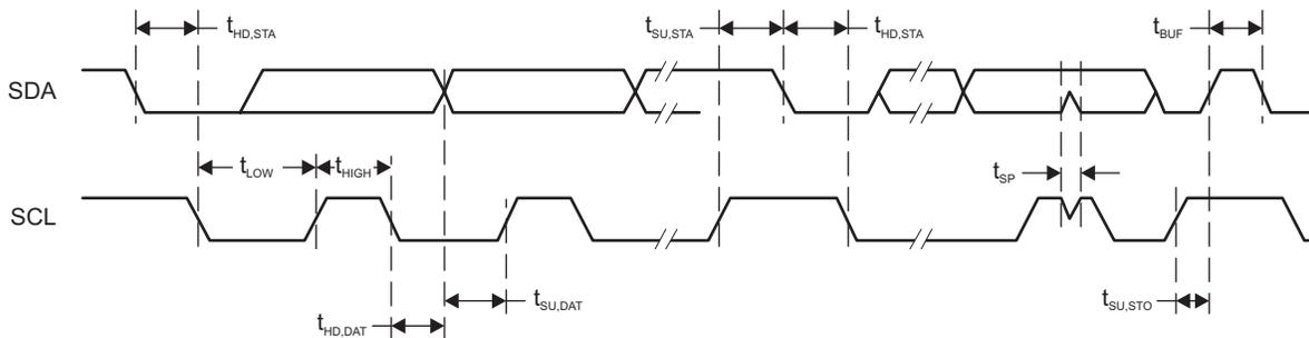
图 5-10. I<sup>2</sup>C Mode Timing
