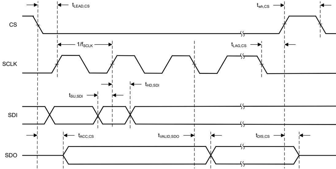
图 6-1. SPI 接口时序图
