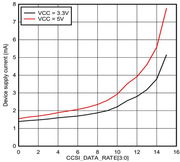
图 6-3. 器件电源电流与 CCSI\_DATA\_RATE 间的关系
