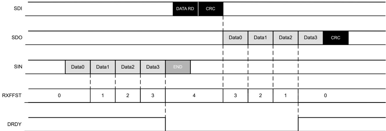
图 7-6. RXFFLV 寄存器设置为 3 时的 DRDY 引脚示例
