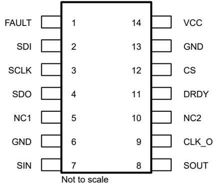
图 5-1. LP5899 DYY 封装 14 引脚 SOT-23-THN 顶视图
