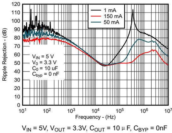
图 5-9. Ripple Rejection vs Frequency (New Chip)
