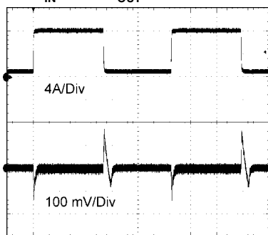
瞬态响应 V_{IN}=12V · V_{OUT}=1.2V 1至8A阶
