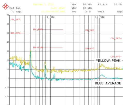
LMS3655-Q1 传导 EMI：V<sub>OUT</sub> = 5V，I<sub>OUT</sub> = 5A
