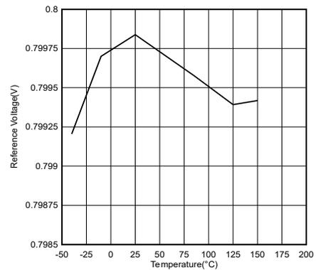
图 6-12. 基准电压与温度间的关系
