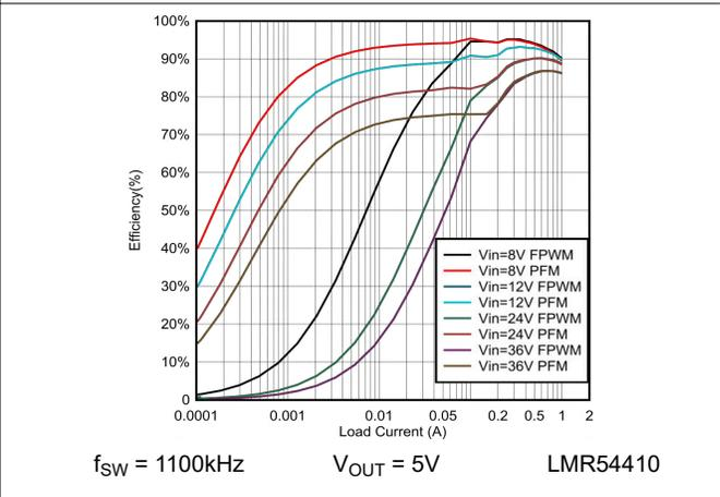
图 6-4. 效率与负载电流间的关系 (5V)
