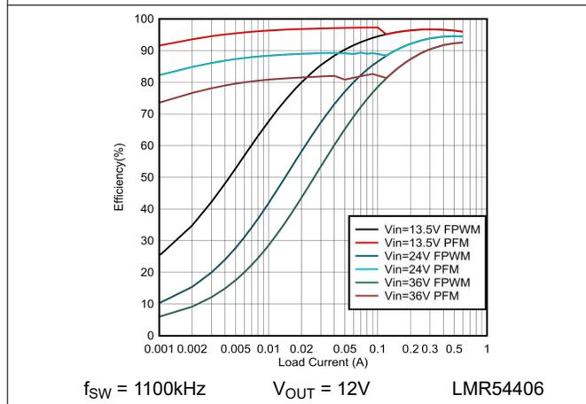
图 6-5. 效率与负载电流间的关系 (12V)
