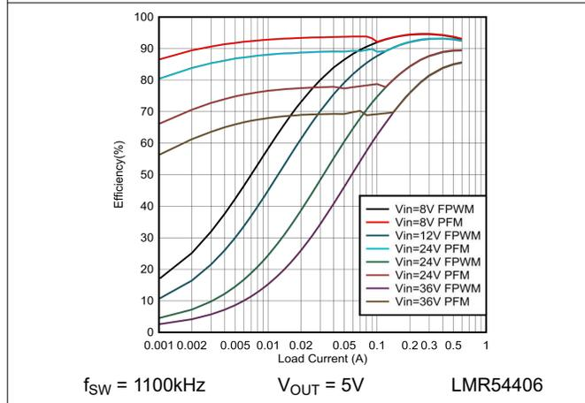
图 6-3. 效率与负载电流间的关系 (5V)
