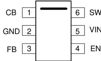
图 5-1. 6 引脚 SOT-23 DBV 封装 (顶视图)
