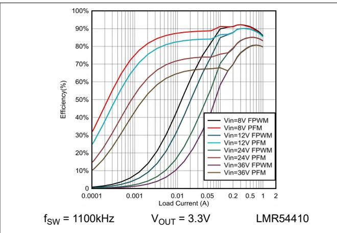
图 6-2. 效率与负载电流间的关系 (3.3V)
