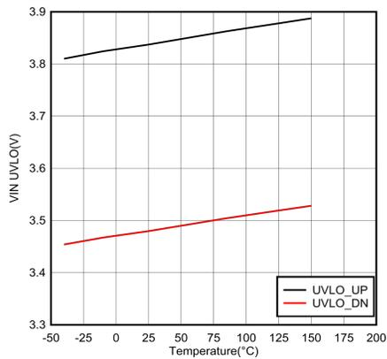
图 6-11.  $V_{IN}$  UVLO 与温度间的关系
