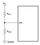
图 8-1. VIN UVLO Using the EN Pin
