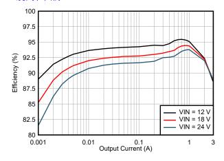
效率: V<sub>OUT</sub> = 5 V (固定值)、400 kHz
