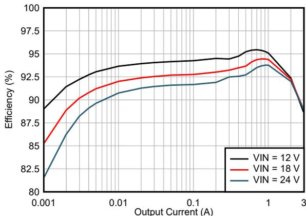
效率： $V_{OUT} = 5V$ （固定值）、400 kHz
