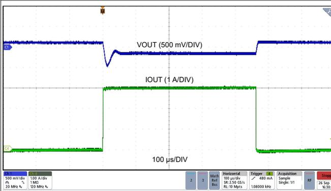
LMQ66430R5R  $V_{OUT} = 5\text{ V}$  400 kHz (Auto)
