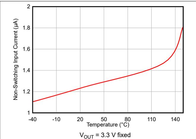
**图 7-2. Nonswitching Input Current ( $I_{QVIN(nonsw)}$ ) Versus Temperature**
