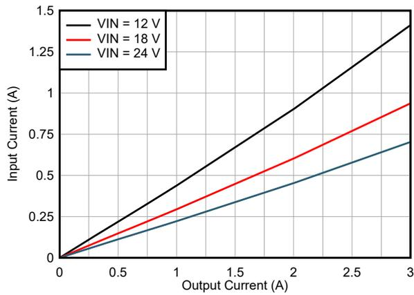
LMQ66430R5R  $V_{OUT} = 5\text{ V}$  400 kHz (Auto)
