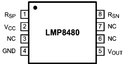
图 5-1. LMP8480 VSSOP 封装 8 引脚 顶视图
