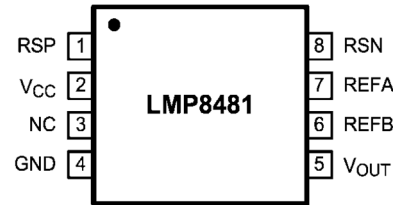
图 5-2. LMP8481 VSSOP 封装 8 引脚 顶视图
