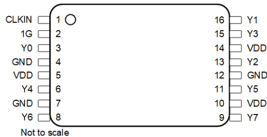
图 5-7. LMK1C1108-Q1, 16 引脚 PW TSSOP 封装 (顶视图)
