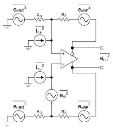
图 63. FDA Noise-Analysis Circuit
